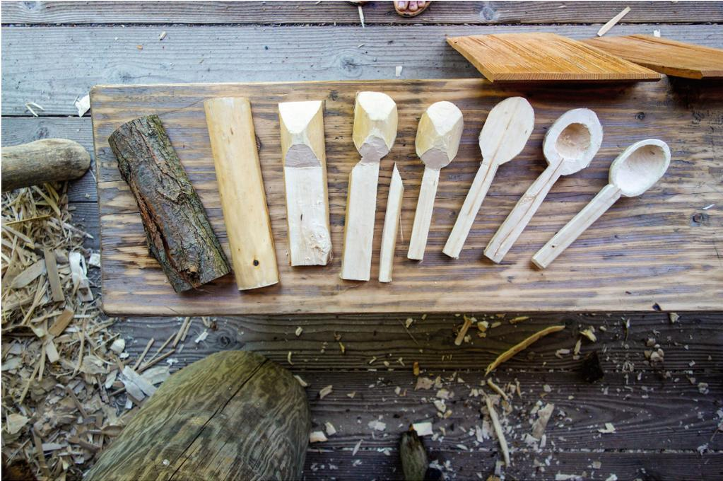
Abb. 14: Die Entstehung eines Holzlöffels. Produktion W. Lobisser 2022. – *The making of a wooden spoon. Production W. Lobisser, 2022.*
