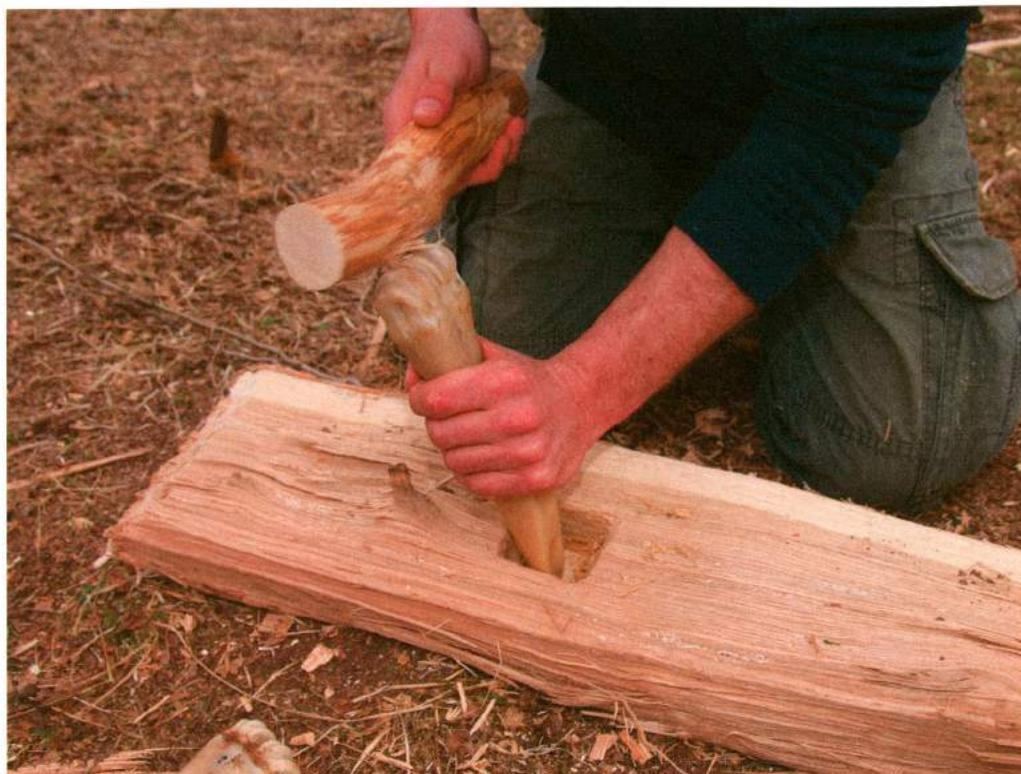
Abb. 25: Arbeiten mit einem Meißel aus Knochen. – Working with a bone chisel.
