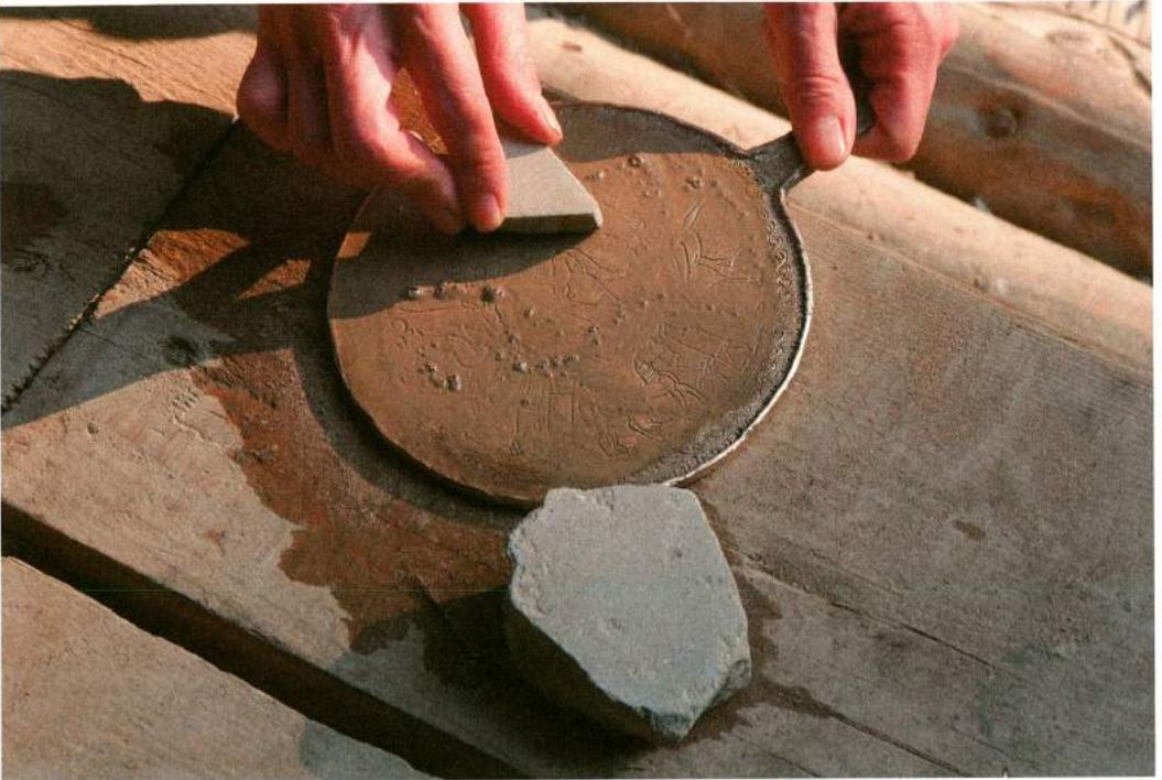
*Fig. 9: Working with an abrasive stone on the rough-cast mirror. – Arbeiten mit dem Schleifstein am Rohgussspiegel.*
