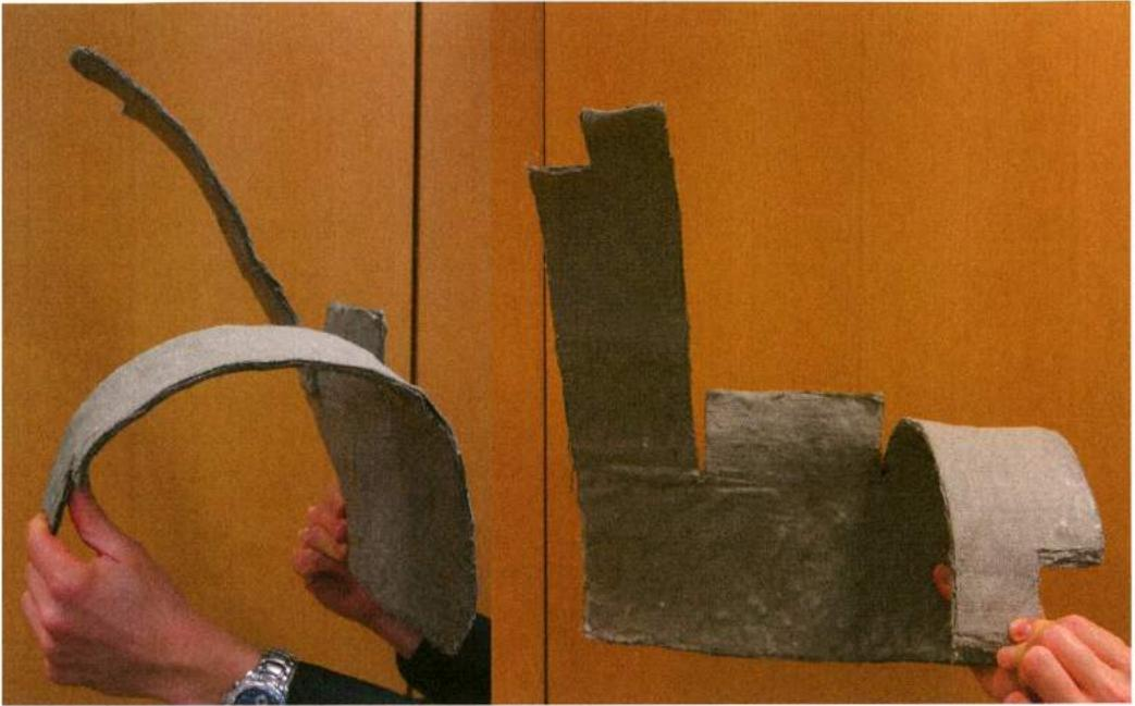
Abb. 8: Schulterpartie aus Leinenstoff mit Stärkeleim verklebt. Die Flexibilität ist deutlich erkennbar. – Yoke made from linen glued with starch glue. The flexibility is clearly visible.
