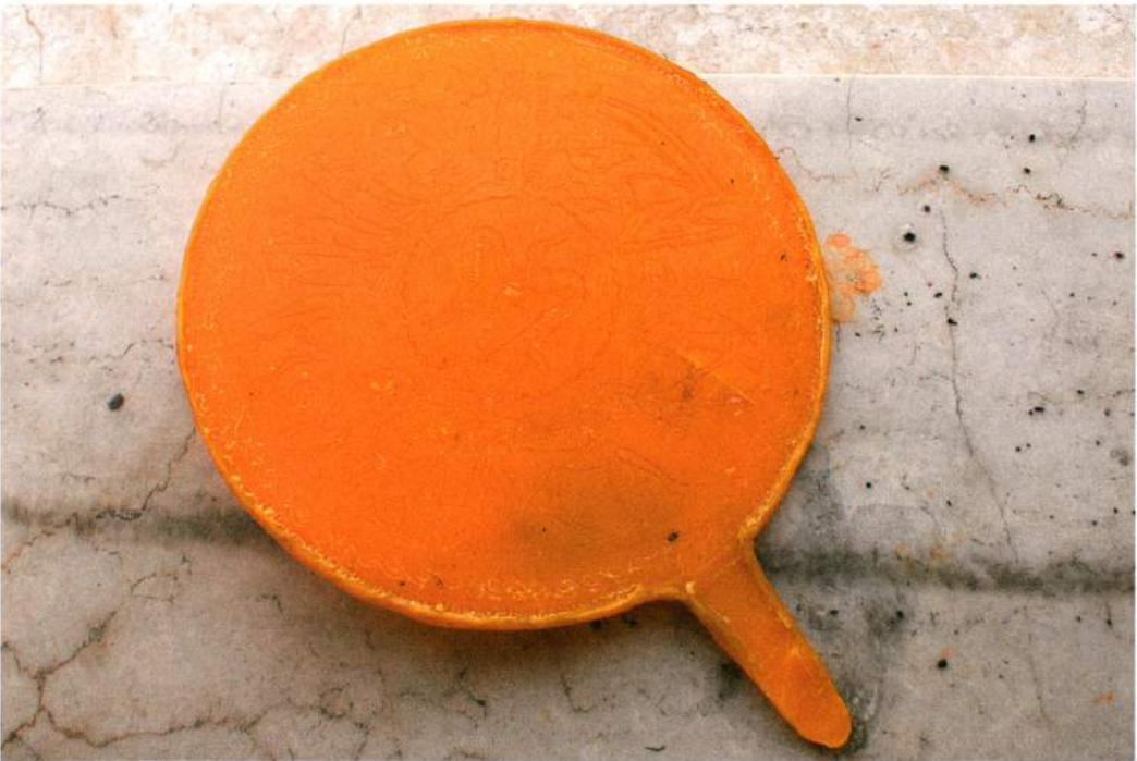
*Fig. 4: Finished wax model (front and rear). – Fertiges Wachsmodell (Vorder- und Rückseite).*
