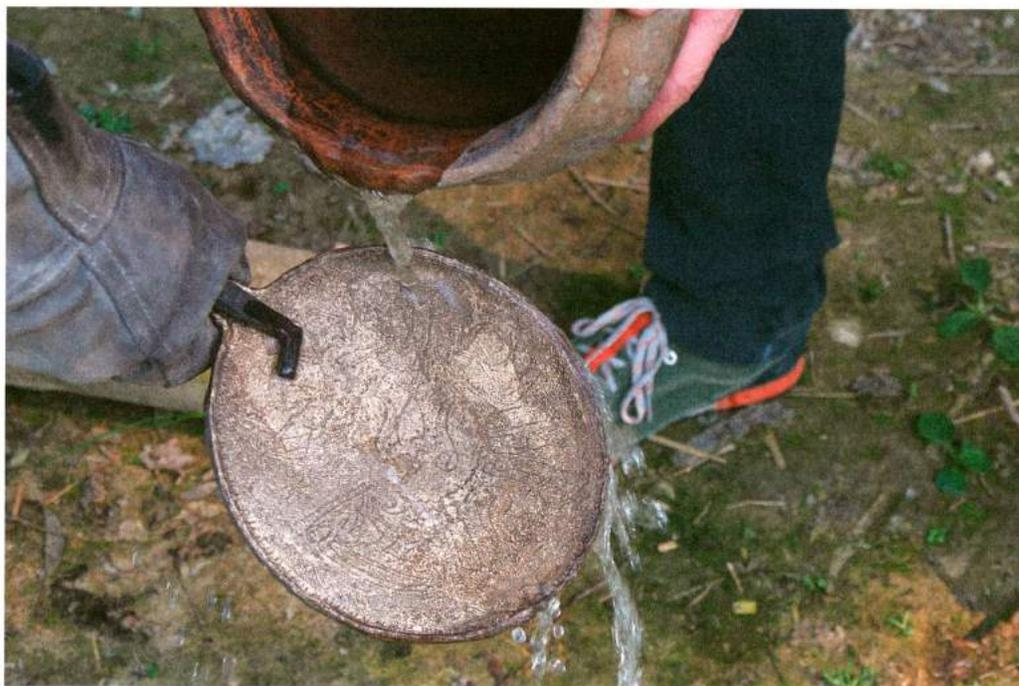
*Fig. 8: Rough-cast mirror. – Grober Spiegel nach dem Guss.*
