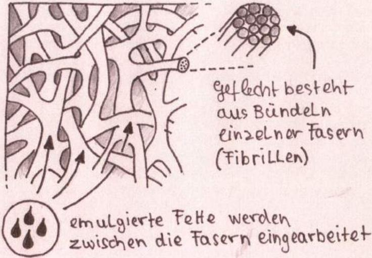
Abb. 1: Schematische Struktur des Fasergeflechts einer Haut, welche das Prinzip einer Fettgerbung demonstriert. – Schematic structure of the fiber network of a hide, which demonstrates the principles of fat tanning.
