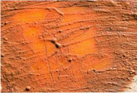
*Fig. 6: First layer of refractory material. – Erste Schicht aus feuerfestem Material.*
