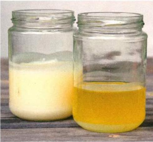
Abb. 11: Ausgehärtetes (links) und noch flüssiges (rechts) Unschlitt. Unschlitt härtet unter 40°C vollständig aus. – Solid (left) and still liquid (right) tallow. Tallow solidifies at temperatures below 40°C.
