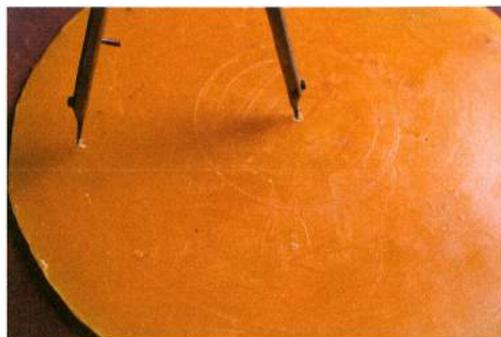
Fig. 3: Creation of six concentric circles using an iron compass. – Herstellung von sechs konzentrischen Kreisen mit Hilfe eines Eisenzirkels.
