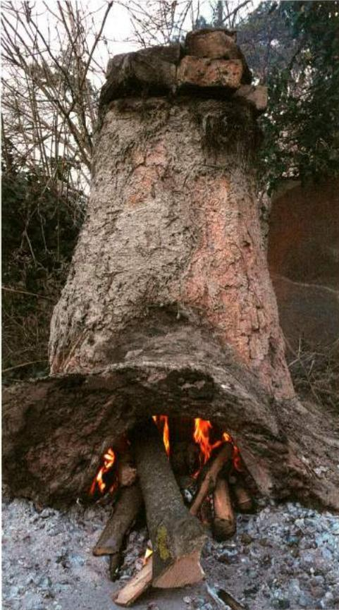
Abb. 9: Der Lehmofen, in dem drei der Flaschen reduzierend gebrannt wurden.
