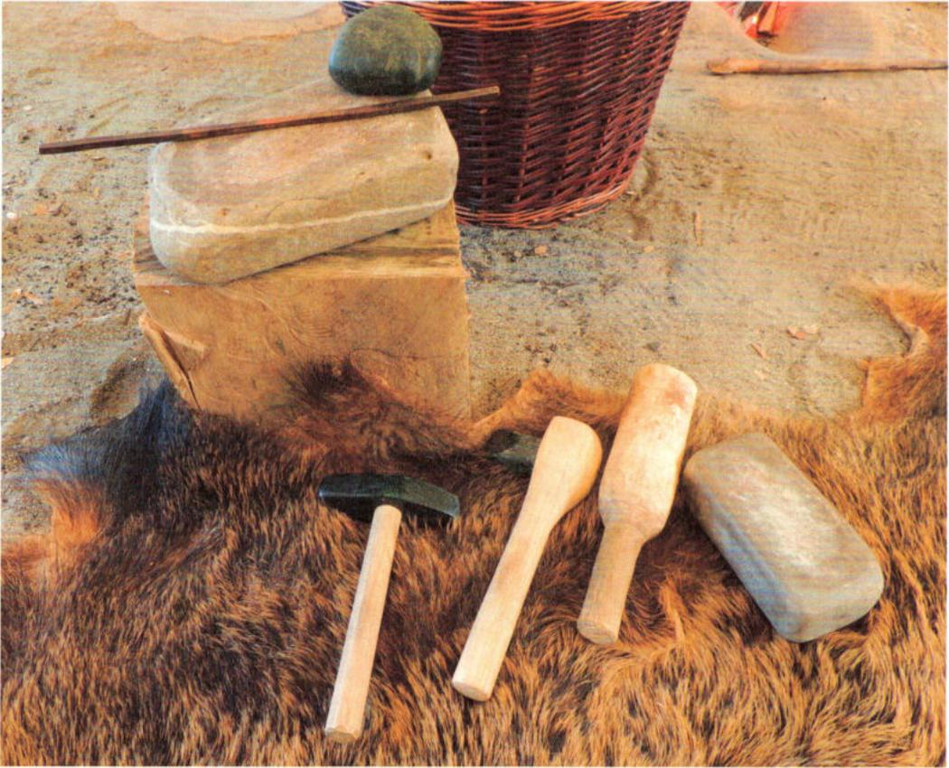
Abb. 2: Werkstattausrüstung zum Schmieden: Steinambosse, Grünsteinhandstück und Grünsteinhammer, Holzschlegel. – Workshop forging equipment: stone anvils, greenstone hand stone and greenstone hammer, wooden mallet.
