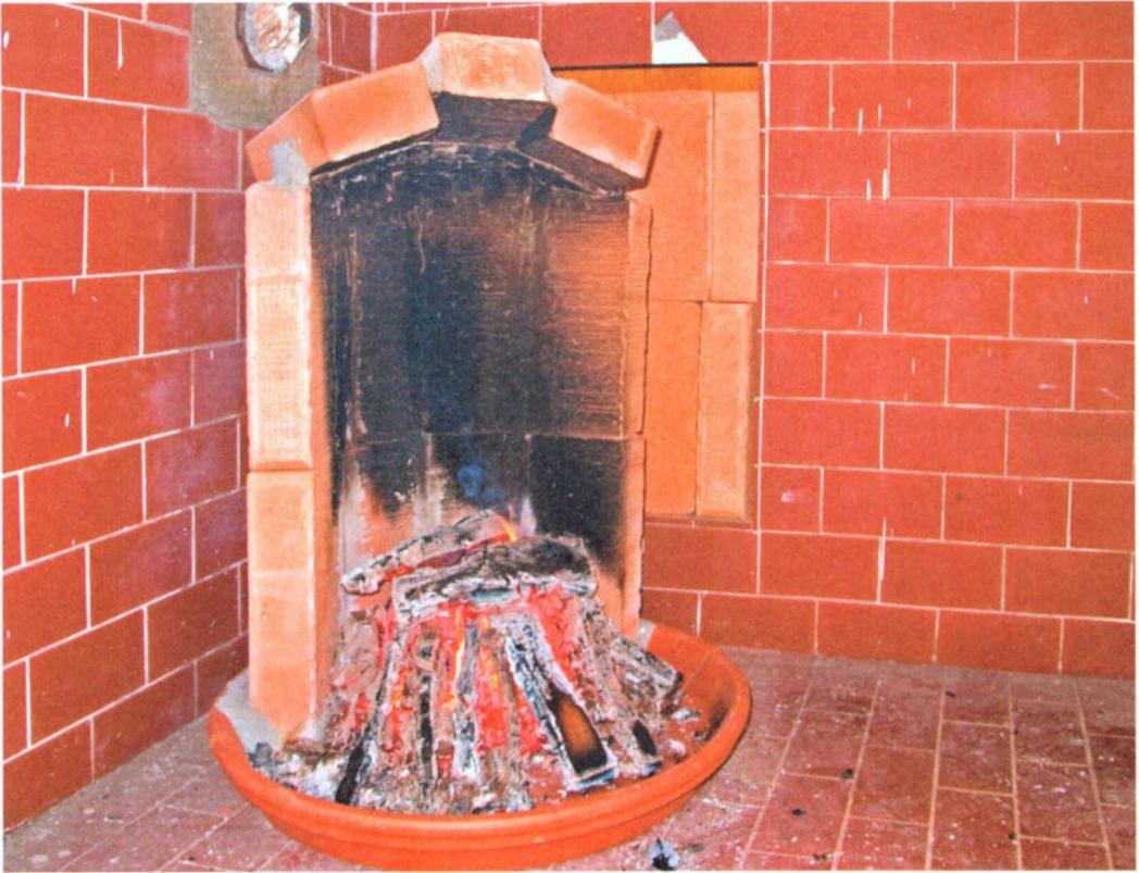
*Abb. 12: Der Nischenofen nach dem Abbrand des Holzes; im Gegensatz zur vorhergegangenen mehrstündigen Beheizung mit Holzkohle hat sich jetzt selbst bei der nur kurzen Abbrandzeit bereits reichlich Ruß gebildet. – The „Nischen-ofen“ after the wood has burned down; as opposed heating with charcoal, which lasted several hours, there is a lot of visible soot after only a short firing with wood.*
