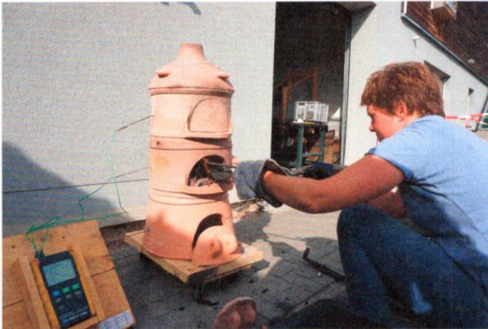
*Fig. 8: Charging charcoal through the hearth opening. Leaving the hearth stopper open for too long also led to a steep drop in temperature. – Laden der Holzkohle durch die Herdöffnung. Auch das zu lange Offenlassen des Herdstoppers führte zu einem starken Temperaturabfall.*
