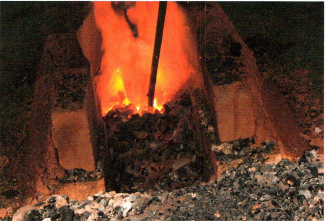
Abb. 5: Polen,  $O_2$  wird reduziert. – Pooling, deoxidation in progress.
