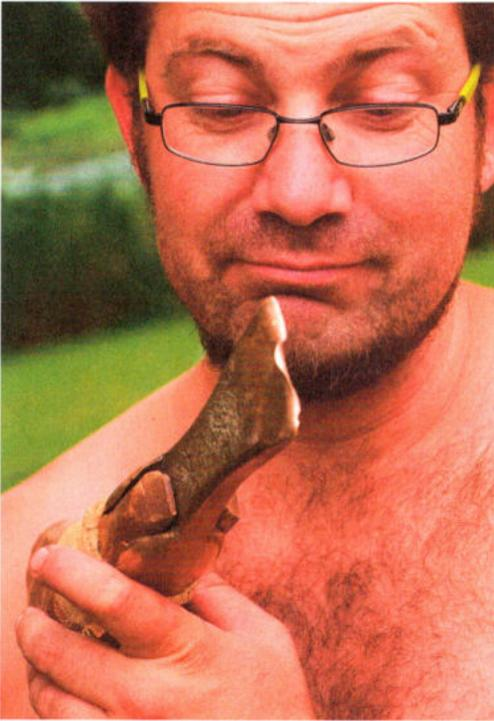
*Abb. 10: Versehentlich benutzten wir eine Bronzeklinge, ohne sie vorher durch Kaltschmieden gehärtet zu haben. – By mistake we used a bronze blade before hardening it through cold hammering.*
