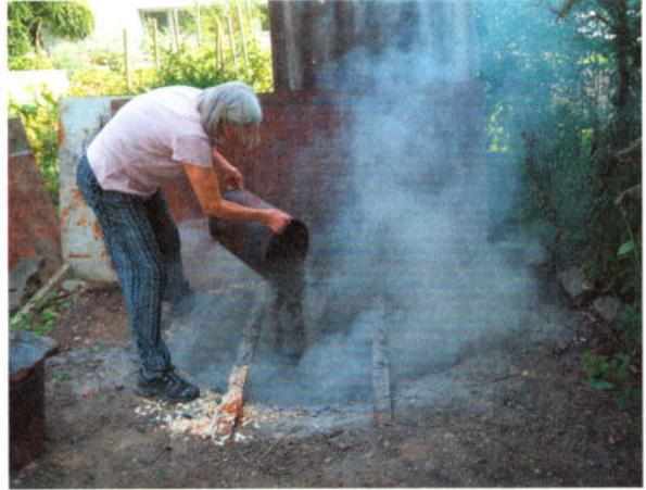
*Abb. 8: Beim Erstickten des Feuers mit Sägemehl und Asche schlagen die Flammen hoch und es entsteht CO-haltiger Rauch. – Smothering the fire with sawdust and ashes makes the flames leap up and produces CO-containing smoke.*
