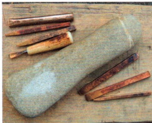
Abb. 3: Werkstattausrüstung zum Ziselieren und Tauschieren: Punzen, Meissel, Durchschläge, Steinschlägel. – Workshop equipment for chasing and damascening: punches, chisels, stone mallet.
