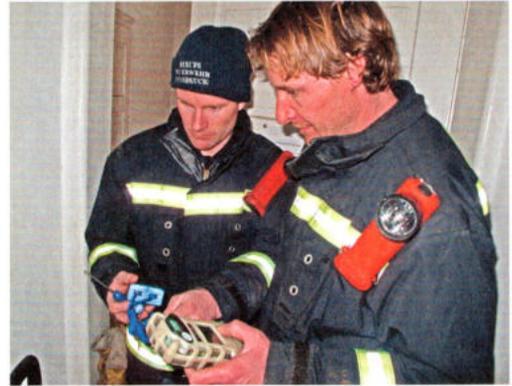
Abb. 10: Messung von Temperatur, CO- und CO<sub>2</sub>-Konzentration im Versuchsraum. – Taking the values of temperature, CO- and CO<sub>2</sub>-concentration in the testing room.
