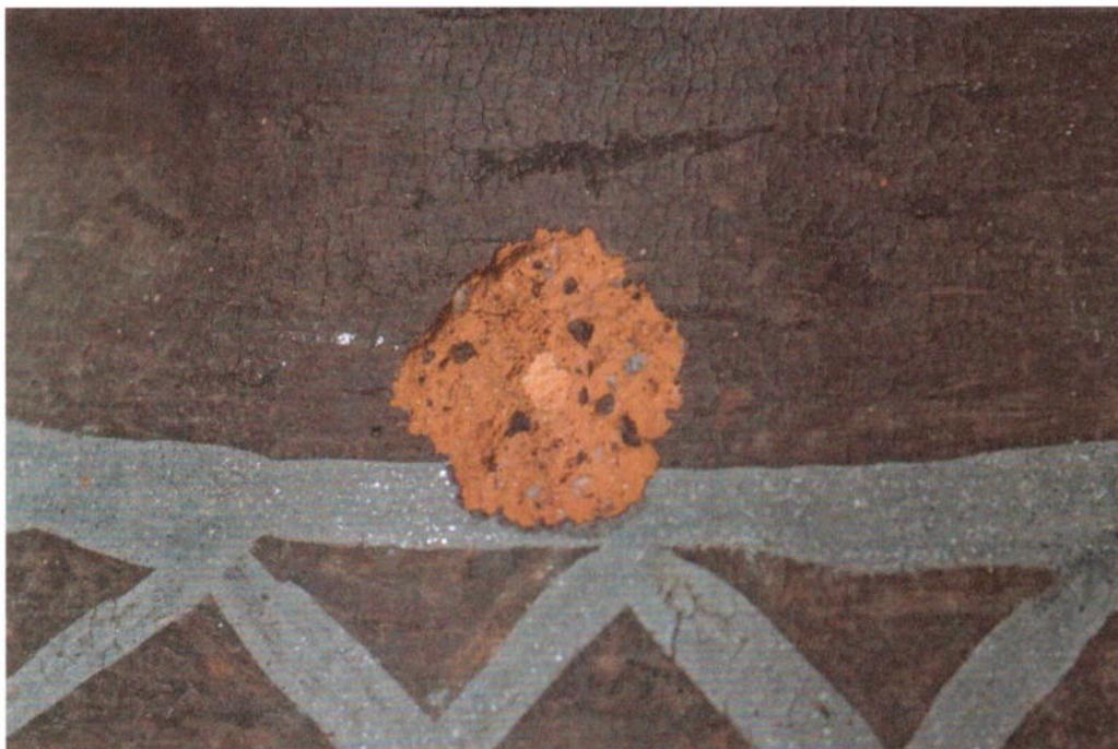
Abb. 2: Abplatzung an einer Replik, verursacht durch ein Kalkbröckchen im Ton („Kalktreiber“). – Damage on a replica caused by a piece of lime in the clay.
