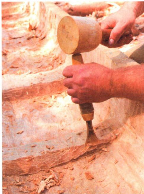
*Abb. 15: Bei der Endgestaltung der Querrippen setzten wir unseren Randleistenmeißel aus Bronze ein. – To carve the end surface of the crosswise ribs we used our sidebar chisel made of bronze.*
