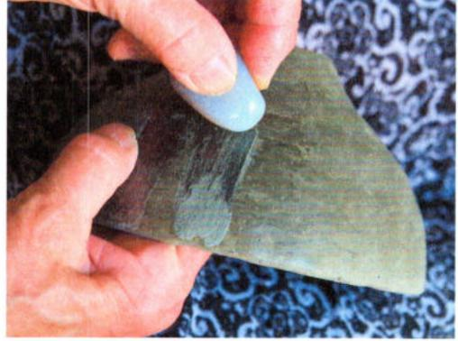
Abb. 5: Graphitbemalung muss vor dem Brennen poliert werden. – A graphite engobe has to be polished before firing.
