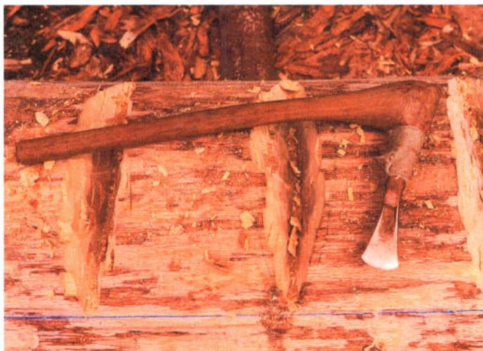
*Abb. 6: In Abständen von etwa 27 cm wurde das Überholz an der Bodenseite bis zur Markierung eingekerbt. – In distances of about 27 cm, the surplus wood on the bottom side was grooved down to the marking lines.*
