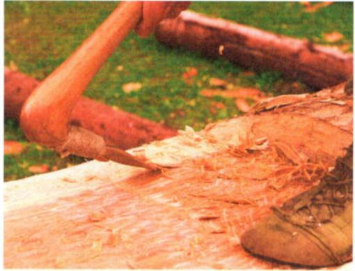
Abb. 7: Nach dem Abspalten des Überholzes wurde die Grundfläche mit unserer Randleistendechsel geglättet. – After splitting away the surplus wood we flattened the bottom with our low-flanged adze.
