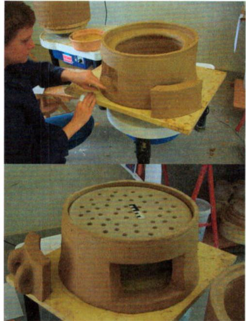
*Fig. 5: Construction of the ash pan with a wide inner lip to hold the perforated floor. Bottom: perforated floor fitted into the top of the ash pan. – Konstruktion des Aschenkastens mit einer breiten Innenlippe zur Aufnahme des perforierten Bodens. Unten: Perforierter Boden, der in die Oberseite der Aschelade eingesetzt wird.*
