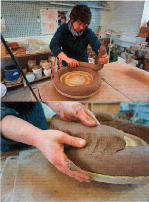
*Fig. 4: Building the furnace sections using the coiling technique. – Bau des Ofens mit Tonwülsten.*
