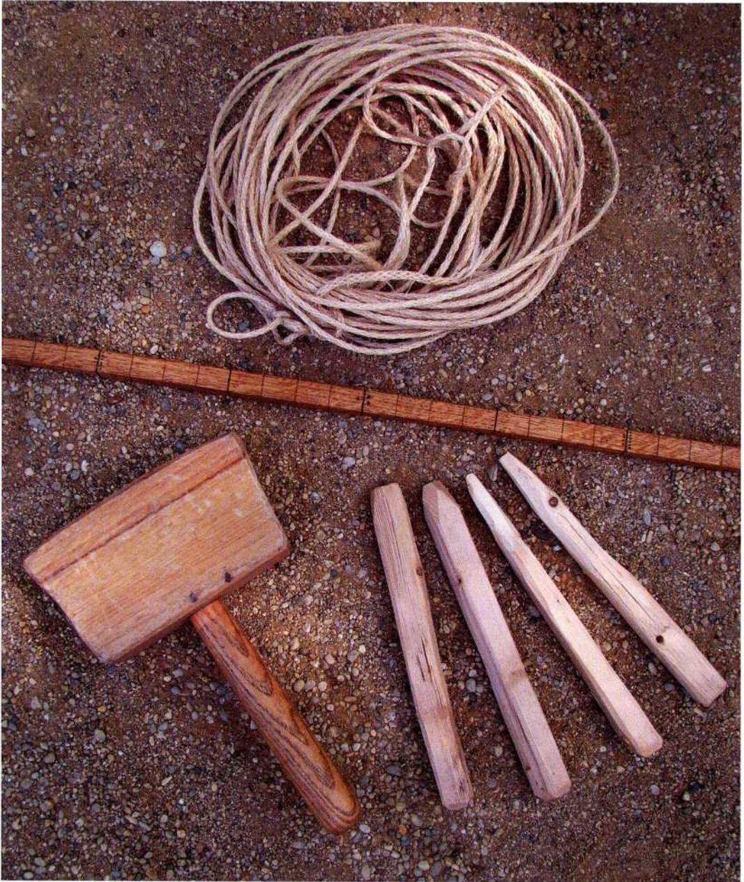
*Abb. 3: Mit Schnüren, Holzpflocken und unserem definierten Modulmaß wurde der Grundriss von Schwechat auf dem Bauplatz abgesteckt. – To create the ground plan of Schwechat on the building site we used organic strings, wooden pegs and our defined module measurement.*
