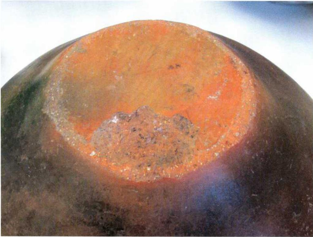
Abb. 6: Abgesprengter Boden. – Blown-off bottom.
