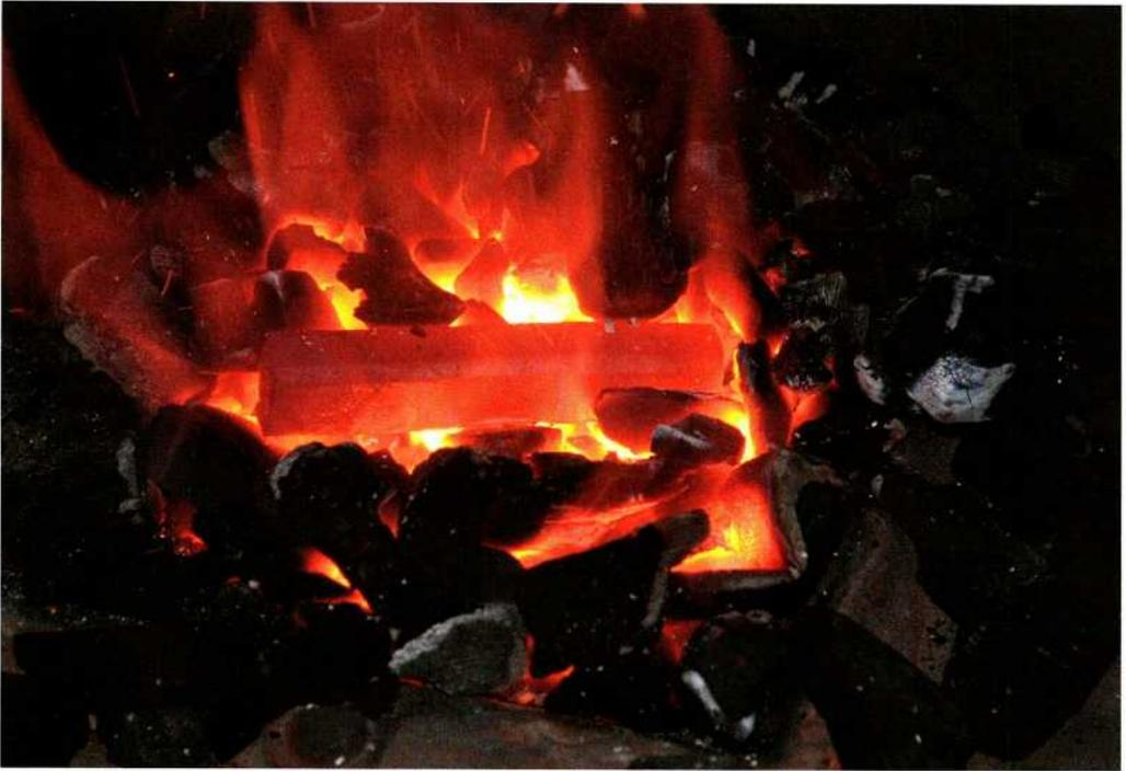
*Abb. 5: Abgelängter Bergeisenrohling im Schmiedefeuer (Holzkohle). – Pick (or gad) blank in the smithy fire (charcoal) after cutting to length.*
