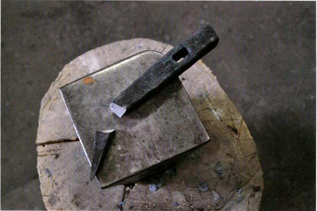
*Abb. 10: Durch gezieltes Überhärten herbeigeführter Spannungsriss im Bereich der Bergeisenspitze. – Stress crack in the point of a pick, induced by purposeful overcuring.*
