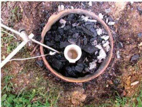
Fig. 5: Melting a gold concentrate extracted from the Ada Tepe ore. – Schmelzen eines Goldkonzentrates extrahiert aus dem Ada Tepe Gold.
