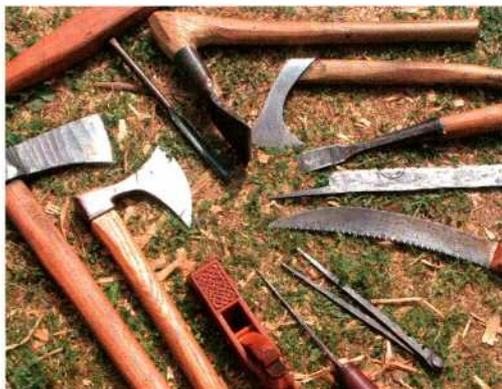
Abb. 2: Nachgebaute Werkzeuge des frühen Mittelalters, die beim Bau der Hausmodelle zum Einsatz kamen: Schaftlochaxt, Bartaxt, Hobel, Ahle, Zirkel, Handsäge, Ziehmesser, Stemmbeitel, Franziska, Lappendechsel und Löffelbohrer. – Replicas of middle age tools that were used to build up the house models: different axes, plane, awl, dividers, hand saw, drawing knife, chisel, Franziska, adze and spoon drill.
