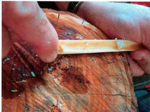
Abb. 6: Das nasse Material lässt sich sehr viel einfacher bearbeiten. – It is much easier to work on wet material.
