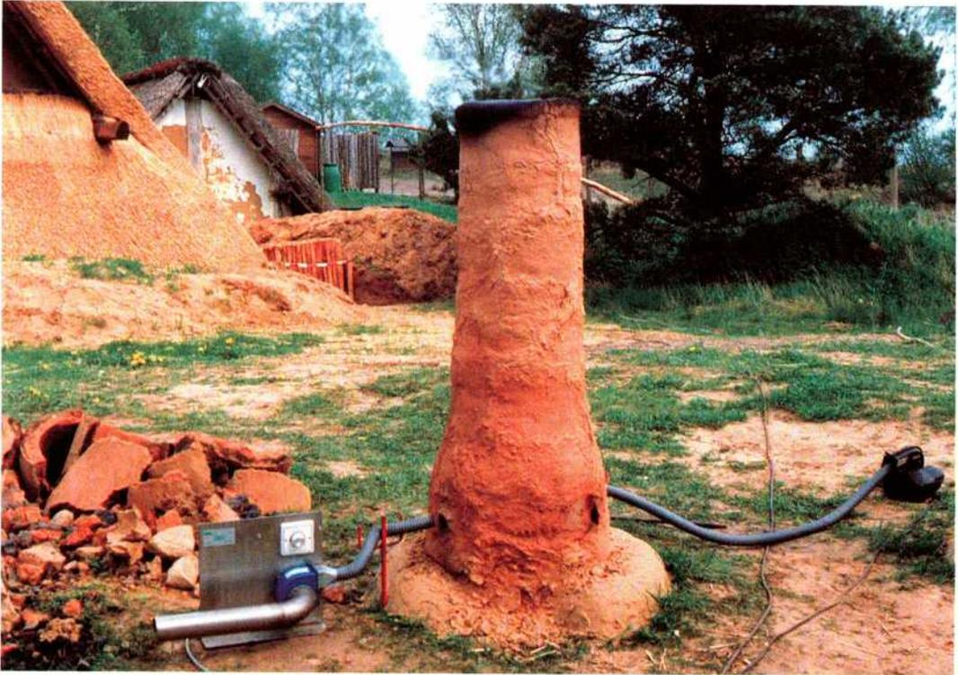
Abb. 5: Luftzufuhr über Gebläse. – Wind supply by fan.
