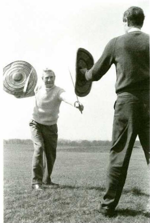
Abb. 2: Testen eines Metallschildes und eines Lederschildes mit Bronzeschwertern – Testing of a metal buckler (left) and a leather buckler with bronze swords.
