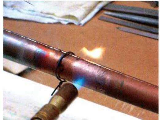
*Fig. 5: Pour the workpieces made of copper alloy (above) and soldering the organ pipes of the double-organ. – Gießen der Werkstücke aus einer Kupferlegierung (oben) und Lötten der Orgelpfeifen der Doppelorgel.*
