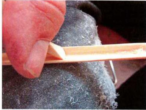
Abb. 5: Die Bearbeitung mit dem Zahn im trockenem Zustand. – Processing with the tooth in dry state.
