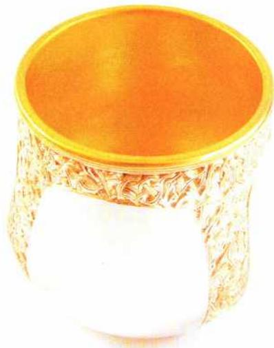
Abb. 15: Nach dem Feuervergoldeten ist die Goldschicht matt und muss noch poliert werden. – After fire-gilding the gold layer is matt and has to be polished.
