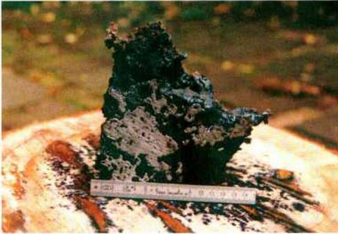
Abb. 6: Schnitt durch eine Luppe. –
