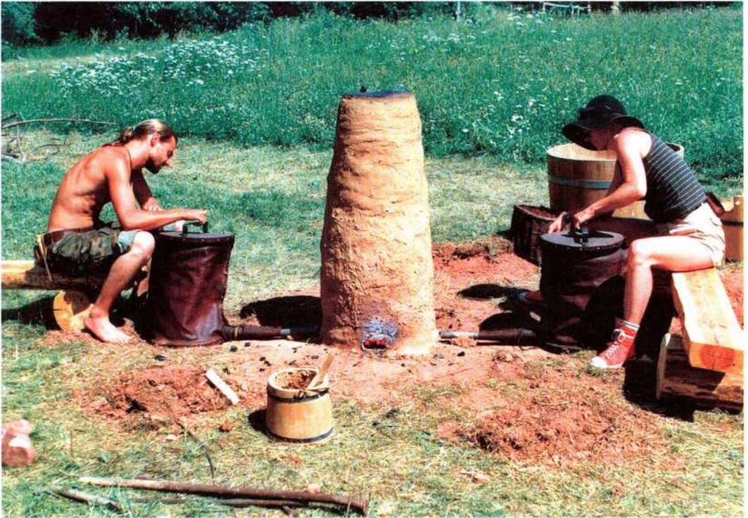
Abb. 4: Luftzufuhr über Blasebälge. – Wind supply by bellows.
