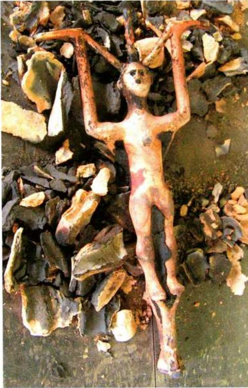
Abb. 7: Der Tonmantel wurde eben vom Rohguss der Figur weggeschlagen. – The clay cloak has been moved from the raw casting of the figure.
