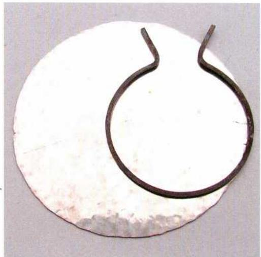
Abb. 5: Die gegessene Silberplatte nach dem Ausschmieden. Der dazugelegte Zwischenring veranschaulicht die Größenzunahme des Silberblechs. – The cast silver disc after hammering. The ring placed aside shows the growth of the silver sheet.
