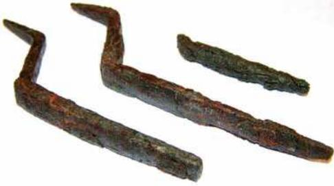
Abb. 3: Gekröpfte Feilen aus Sévaz, Länge 13 und 15 cm. Solche Feilen mit in der Höhe versetztem Griff erlauben das Befeilen ebener Flächen, was mit den heute üblichen Feilen mit geradem Griff nicht möglich ist. – Cranked files from Sévaz, lengths 13 cm and 15 cm. Such files with a moved up handle allow the filing of plane surfaces which isn't possible with today's straight handled files.
