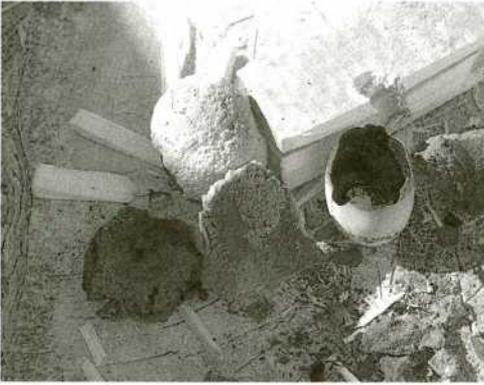
Abb. 6: Schwelversuche mit Gänse-Ei als Retorte 2011. – Experiment with a goose egg as retort.
