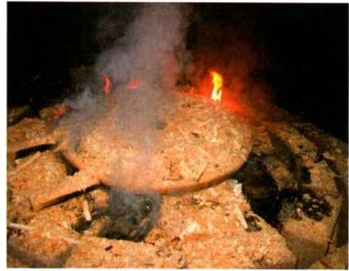
Abb. 8: Das Rad wird auf einer Glutfläche mit einer Abdeckung aus frischen Spänen langsam erhitzt.
