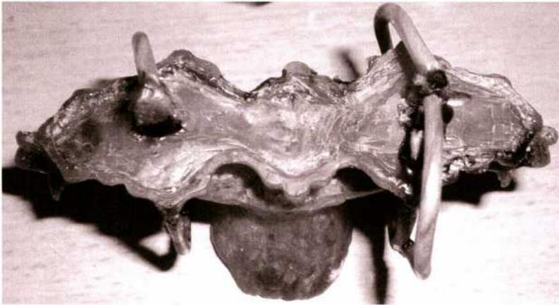
Abb. 7: Beispiel für euterförmigen Einguss und vernetzte Windpfeifen.
