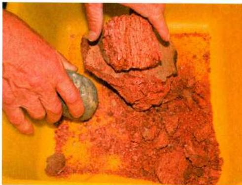
Abb. 2: Zerkleinern einer natürlich erodierten Granitknolle.
