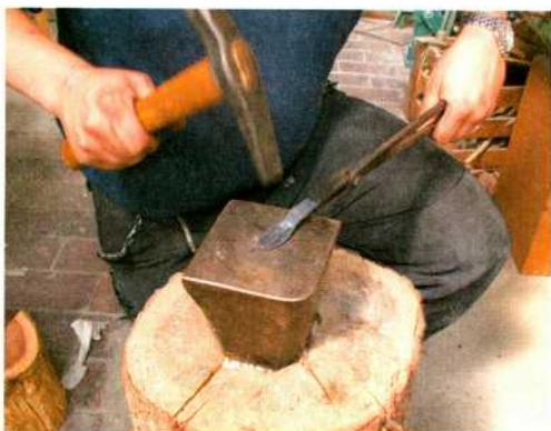
Abb. 5: Ausschmieden des Barrens zu einem ca. 0,4 mm dünnen Blech.
