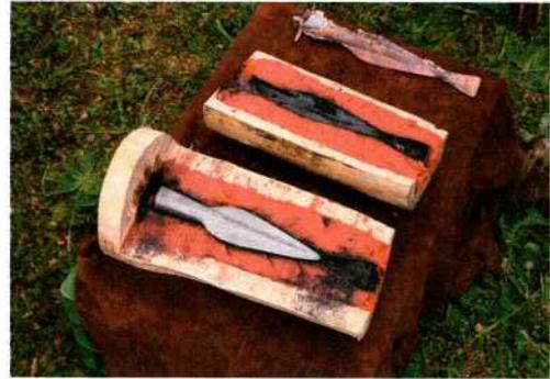
Abb. 12: Die Formkästen und die darin gegossene Lanzenspitze.
