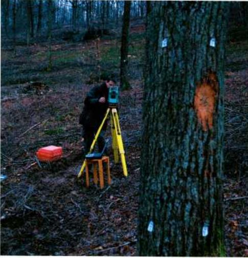
Abb. 2: Einmessen der Eiche mit dem Tachymeter.
