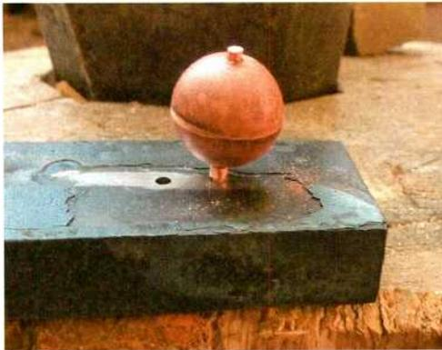
Abb. 12: Vorbereitung zum Vernieten des Kugelkopfes.
