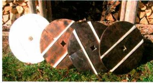
Abb. 11: Rekonstruierte Räder nach Funden aus dem Olzreuter Ried. Von links nach rechts: 1. unbehandeltes Rad; 2. unzureichende Schmauchung eines vorgetrockneten Rades mit gerissenen Bauteilen; 3.-4. erfolgreiche thermische Behandlung im Hitze-Wasserdampf-Verfahren.
