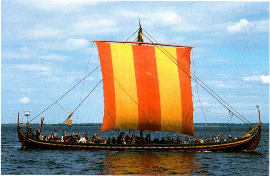
Abb. 2: Havhingsten fra Glendalough, Nachbau des in Irland gebauten Langschiffs Skuldelev 2 von 1042.
