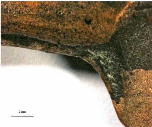
Abb. 7: Ein Gussformmerkmal an einem Originalmesser (Inv.-Nr. 1276-4), entstanden durch nicht exakt übereinstimmende Gussformnegative.
