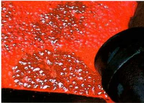
Abb. 4: Oberfläche eines Ochsenhautbarrens, 8 Minuten nach dem Abguss. Es hat sich eine gasundurchlässige Erstarrungshaut gebildet. Das darunter aufgestaute Gas wölbt die Erstarrungshaut an vielen Stellen auf.
