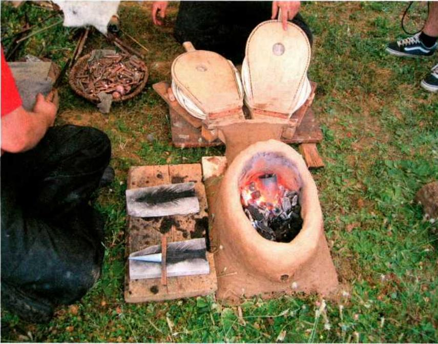
Abb. 4: Die vorbereiteten Specksteinformen mit Kern.
