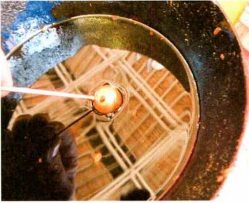
Abb. 11: Fixieren der beiden Halbschalen durch das Eintauchen in ein Harz-Wachsgemisch.
