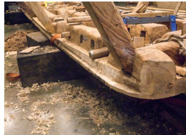
schnell und genau zu entfernen (Abb. 4). Als die Kielplanken angepasst an ihre Querleisten geschnitten waren, begann die Arbeit an den unteren Planken und ihrer durchgehenden Verbindung zum Kiel (Abb. 5).
