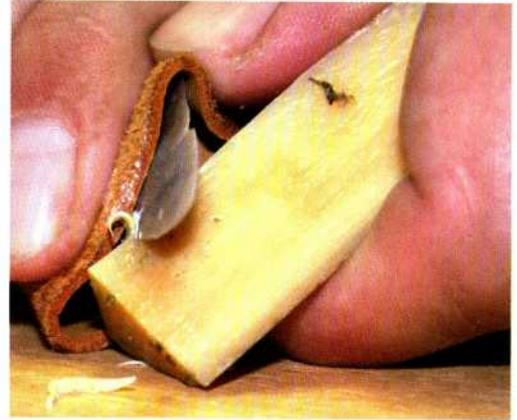
Abb. 8: Schnitzfähigkeit nach Einlegen in Sauerampfersud.
