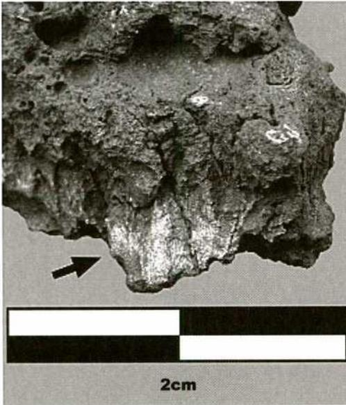
Abb. 21: Schrägansicht eines Gusskuchenfragments mit Rissen und Deformationen an der Bruchfläche. Steiermark, Obertraun-Traunweg, Einzelfund.
