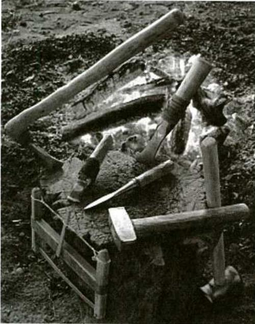
Abb. 23: Werkzeugsatz aus einer Rahmensäge, drei Beilen, einem Meißel und einem mittelschweren bzw. schweren Schaftlochhammer.
