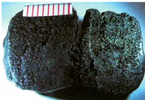
Abb. 4: Schnittfläche eines akera- misch her- gestellten Pechstückes mit erkennbaren Fest- bestandteilen.
