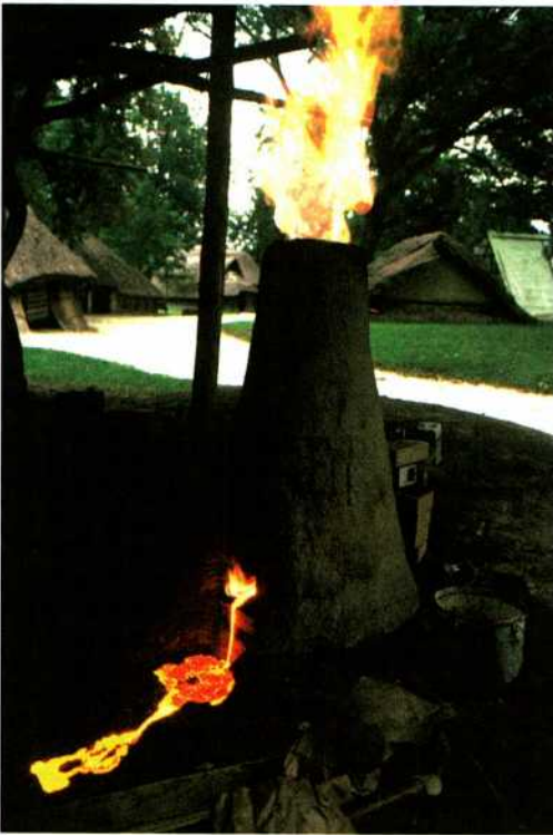
Abb. 4: Asparn/Zaya: Der Rennofen ist angestochen. Experimente zur Verhüttung von Kupfer und Eisen gehören zum Lehrstoff.
