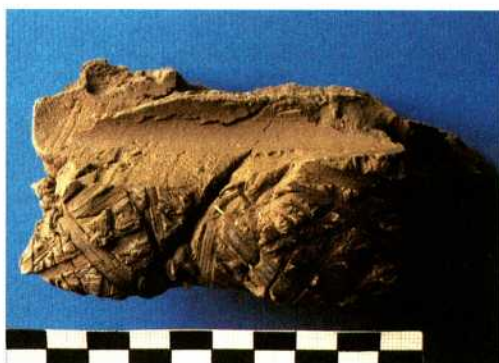
Abb. 6: Lehm aus einer nachgebauten Flechtwand mit Grasabdrücken. Die Strukturen gleichen denen des bronzezeitlichen Hüttenlehms.
