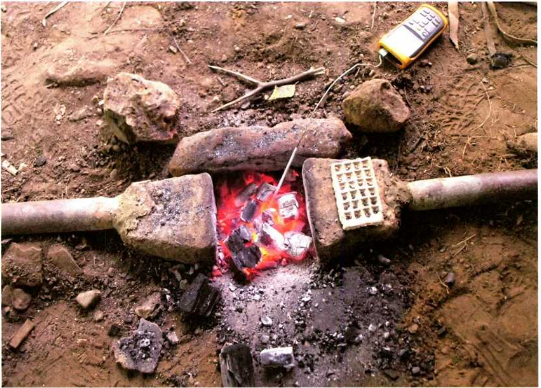
Abb. 9: Schmelzofen mit Luftzufuhr durch Düsenziegel.
