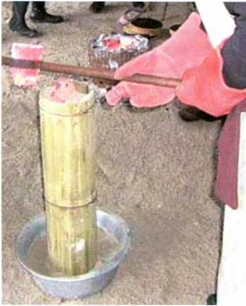
Abb. 4: Der Einguss in die Lehmform. Im Hintergrund der mechanische Blasebalg.
