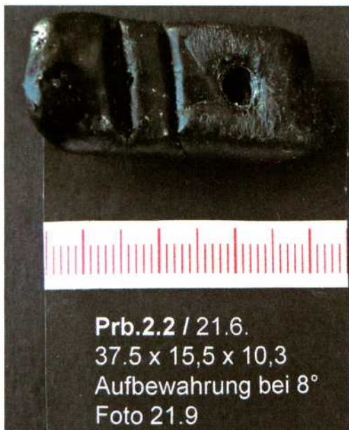
Abb. 5: Probe 2.2. Leicht gebogen, maßliche Veränderungen des Vierkantes innerhalb der Messtoleranz
