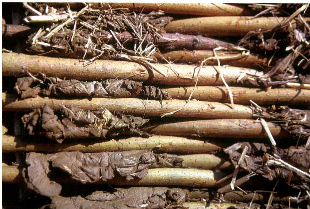
Abb. 7: Die Innenseite einer im Experiment mit Lehm beworfenen Flechtwand zeigt den durchgedrückten Lehm mit Grasabdrücken.
