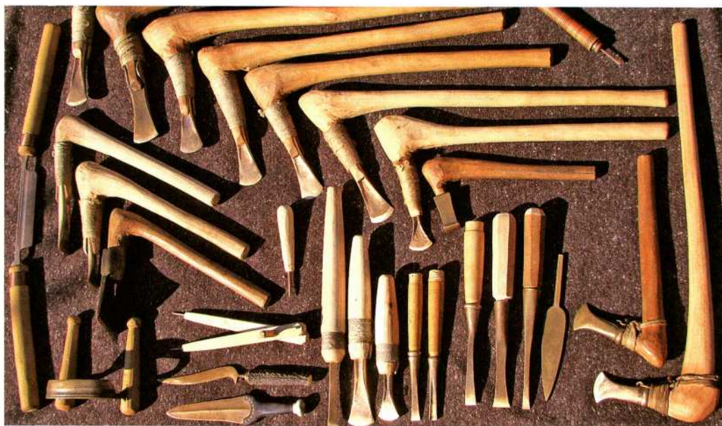
Abb. 2: Nach Originalen gearbeitete Bronzewerkzeuge, die beim Bau des Langhauses im Freilichtmuseum eingesetzt wurden: Randleistenbeile, Tüllenbeile, Lappenbeile, Dechsel, Stemmbeitel, Messer, Ziehmesser, Bohrer, Tüllenhammer, Hohlmeißel, Zirkel, Ahle.
