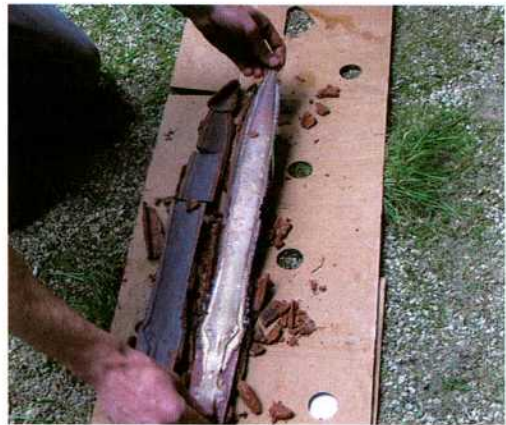
Abb. 5: Aufklappen der Lehmform nach dem Guss.
