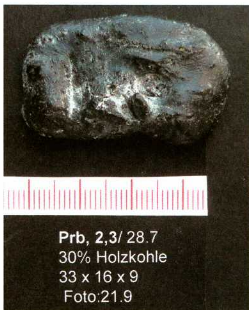
Abb. 7: Probe 2,3 mit 30 Gewichts-% feingesiebter Holzasche verknetet, Ausgangsmaße 33 x 16 x 9,; auf dem Foto 39,5 x 22,5 x 5
