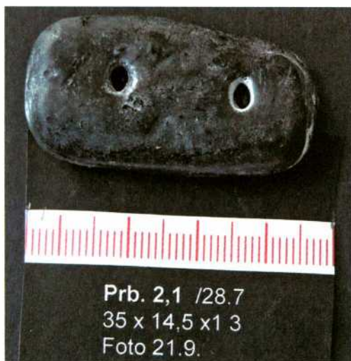
Abb. 6: Probe 2.1. Ausgangsmaße 28.7:35 x 14,5 x 13; auf dem Foto 21.9.: 41 x 21 x 8,7; 2.1. 2011: 47 x 29 x 6,2
