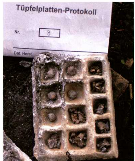
Abb. 10: Für die Vorversuche verwendete Tüpfelplatte mit kugelförmigen Schrötlingen (links) und starker Verschlackung.
