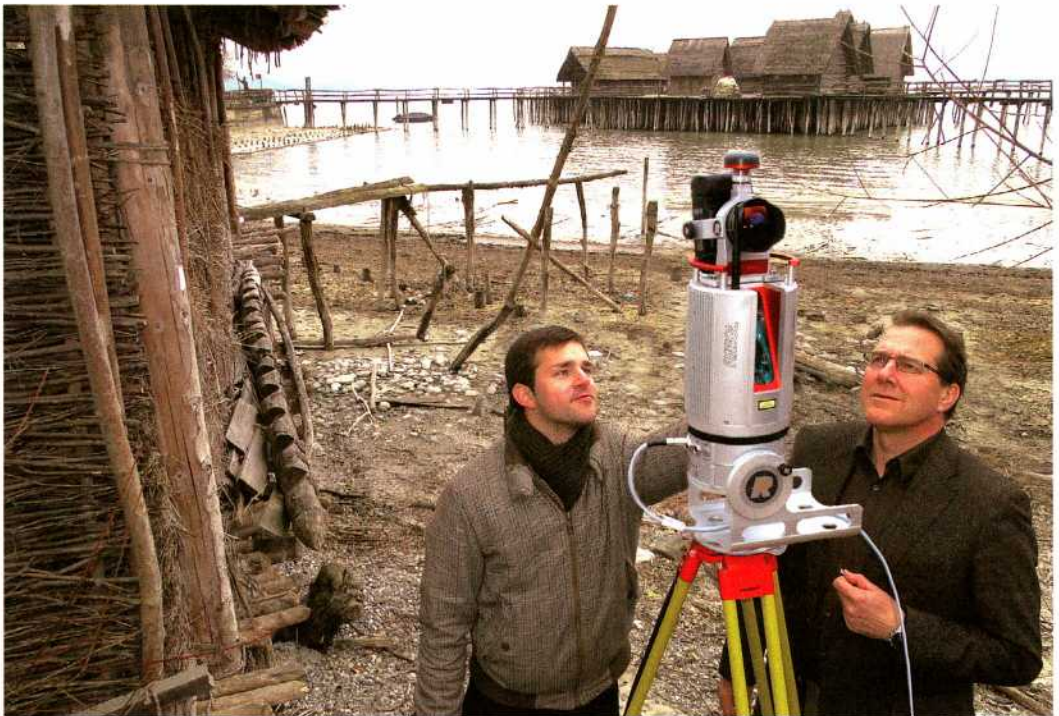
Abb. 1: 3-D-Scann durch die Firma Arctron im Auftrag des Pfahlbaumuseums Unteruhldingen auf dem Experimentierfeld Hornstaadhaus, ca. 100.000 Messungen pro Sekunde, Punkteaflösung 2-5 mm. Februar 2011
