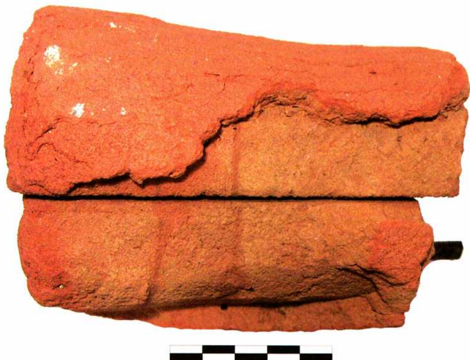
Abb. 2: Teilstück einer gebrannten, zweiteiligen Lehmform. Gut sichtbar ist der zweiphasige Aufbau, die Verschnürungsstellen, sowie rechts die nun verkohlten Überreste eines in die Form eingebetteten Astes.
