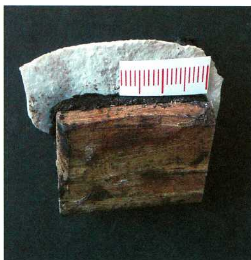
Abb. 8: Pech mit gleicher Gewichtsmenge feingesiebter Holzasche vermischt. Abmessungen eines daraus hergestellten Würfels seit September 2010 unverändert. Ein Teil der Probe zum Einkitten einer Feuersteinklinge in einen Holzgriff verwendet.
