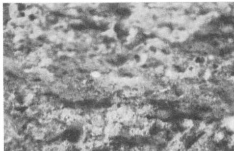
Abb. 2: Bruch eines hergestellten Vergleichstücks mit je 25%vol. Sand-Aschezuschlag, 20 mal vergrößert.
