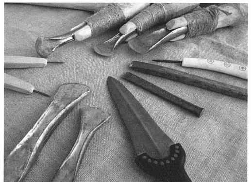
Abb. 6: Einige der von uns nachgebauten und verwendeten Werkzeuge aus Bronze: Randleistenbeile, Dechsel, Zirkel, Dolch, Stemmbeitel und Ahle.
