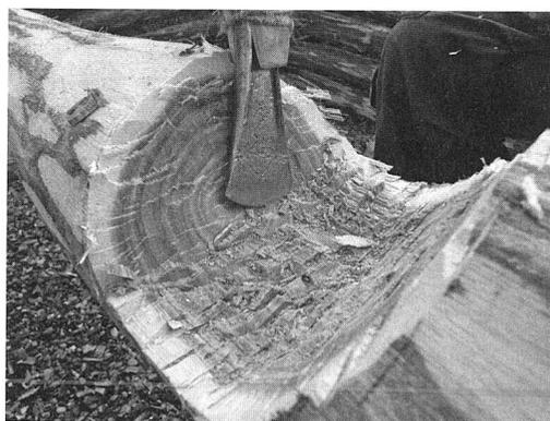
*Abb. 10: Typische Arbeitsspuren bei der Verwendung von Bronzebeilen; die gewölbten Schneiden eigneten sich sehr gut um die runden Ausnehmungen auszuarbeiten.*
