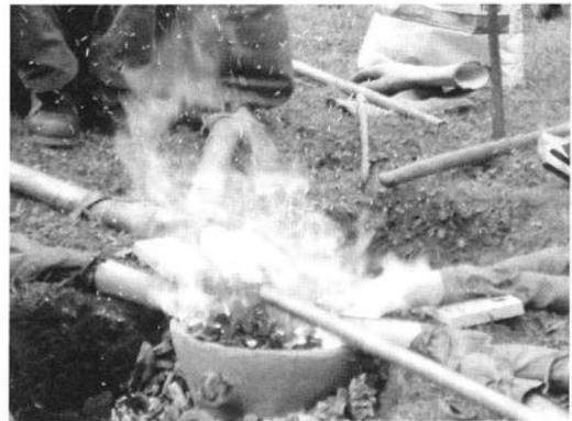
Abb. 19: Die vier Luftdüsen entwickeln eine riesige Hitze, 16 kg Bronze sind in 35 Minuten geschmolzen.
