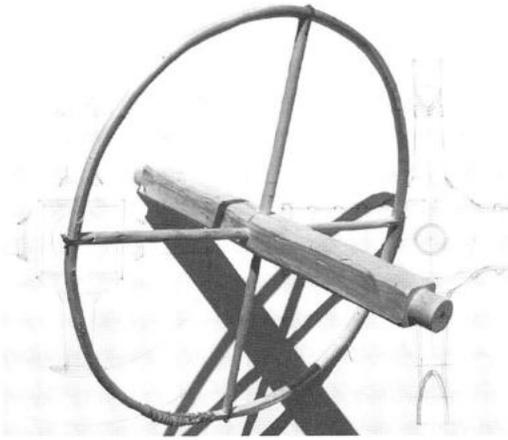
Abb. 4: Ein Gerüst aus Weidenholz dient als Stütze für den Tonkern.
