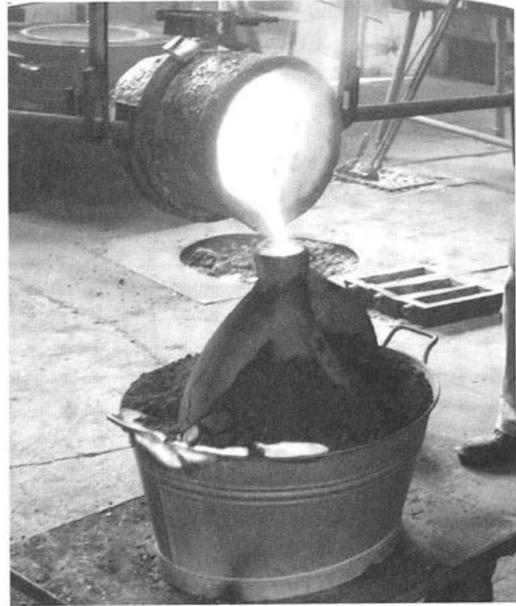
Abb. 10: Der Druck des flüssigen Metalls hat die Form gesprengt, die Schmelze ergießt sich in den Sand.
