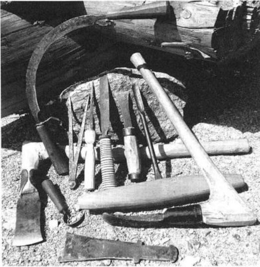
Abb. 4: Der bei den Rekonstruktionsarbeiten verwendete Werkzeugsatz aus Roheisen: endständiges Lappenbeil, Ziehmesser, Lappendechsel, Ärmchenbeil, Stemmbeitel, Löffelbohrer, Reißnadel, Säge, Zirkel, Schnitzmesser.
