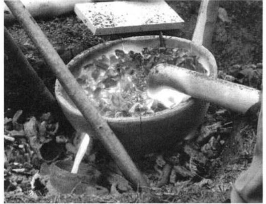
Abb. 20: Durch die Ausgussöffnung in der Tiegelwand fließt die Bronze in die Form.
