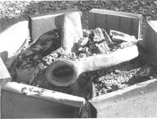
Abb. 9: Blick in den Eingusstrichter der gebrannten Form.
