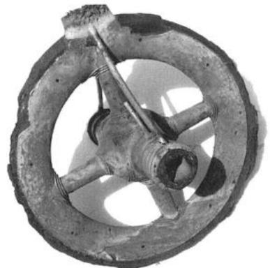
Abb. 21: Das fast vollständig gegossene Rad des dritten Gussversuchs.
