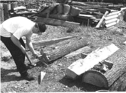
Abb. 4: Spalten der Stammtrommeln.
