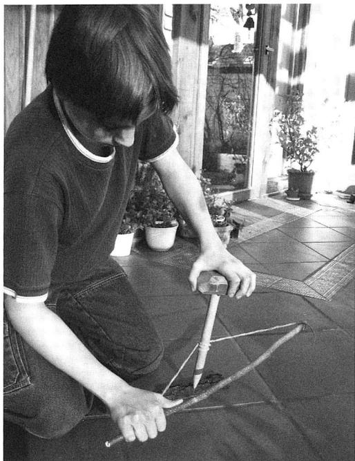
Abb. 5: Loch-Sägen mit Holzbogenbohrer.
