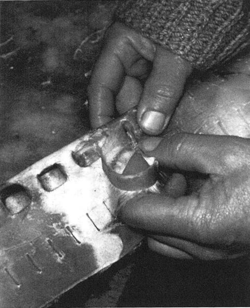
Abb. 9: Die an einem Ende zugespitzten Lederriemen aus Rohhaut wurden ohne Hilfsmittel von Hand in die vorgelochten Schlitze der Konstruktionsteile eingefädelt.
