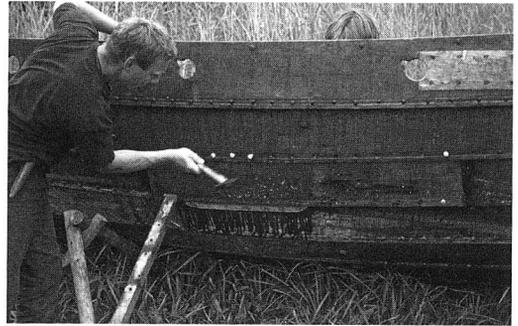
Abb. 9: Einfügung eines neuen Plankenstücks.
