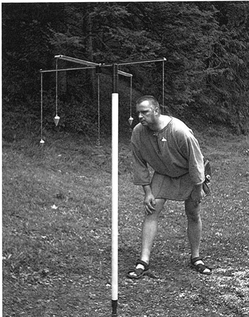
Abb. 4: Ein „römischer Vermesser“ mit Groma bei der Arbeit an der Originaltrasse der *Via Claudia Augusta*. Bei Windstille können die Fluchtpunkte exakt festgelegt werden.
