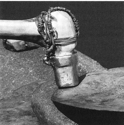
Abb. 4: Ausschmieden der Rohform mit dem Bronzehammer auf dem Steinamboss.
