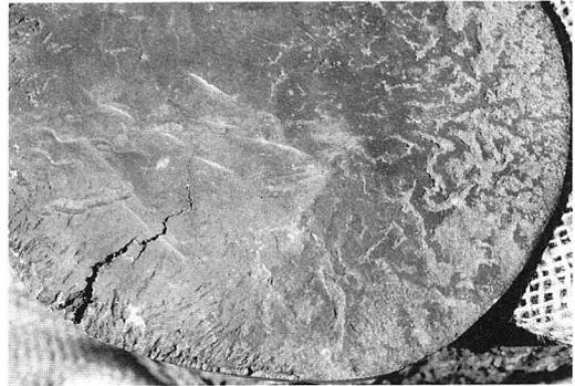
Abb. 6: Ausgeschmiedeter Gusskuchen aus einem offenen Herdguss.
