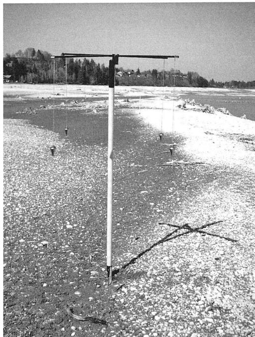
Abb. 1: Groma und Messstab beim Einsatz auf der Originaltrasse der Via Claudia Augusta im ausgelassenen Forggensee zwischen Füssen und Roßhaupten.
