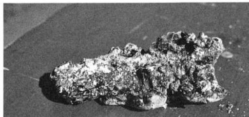
Abb. 11: Das Ergebnis unseres archäologischen Experiments: Die Luppe. Im oberen Teil sind noch Schlackenreste auszumachen, die durch Erhitzen ausgeschmiedet werden.
