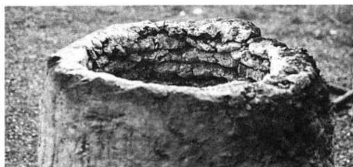
Abb. 10: Der verfärbte Innenrand des Rennofens. Deutlich ist die gelb-rosa Verfärbung (Schwefel) zu sehen, die den Erfolg des Experiments schon voraussehen lässt.
