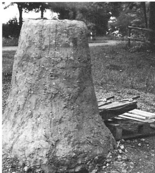
Abb. 9: Der angeheizte Ofen. Unten sieht man die Glut. Im Hintergrund der angesetzte Doppelblasebalg.
