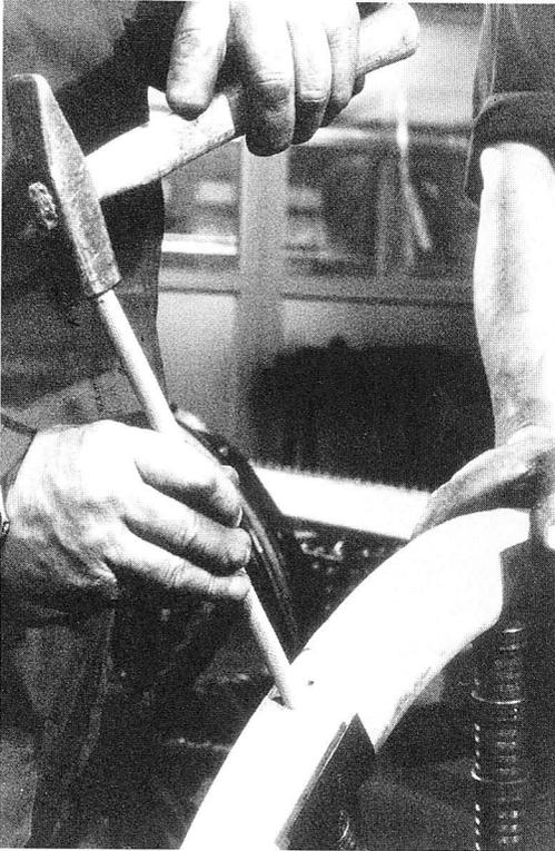
Abb. 7: Die abgeschrägten Enden der Felge sind mit Holzdübeln befestigt.
