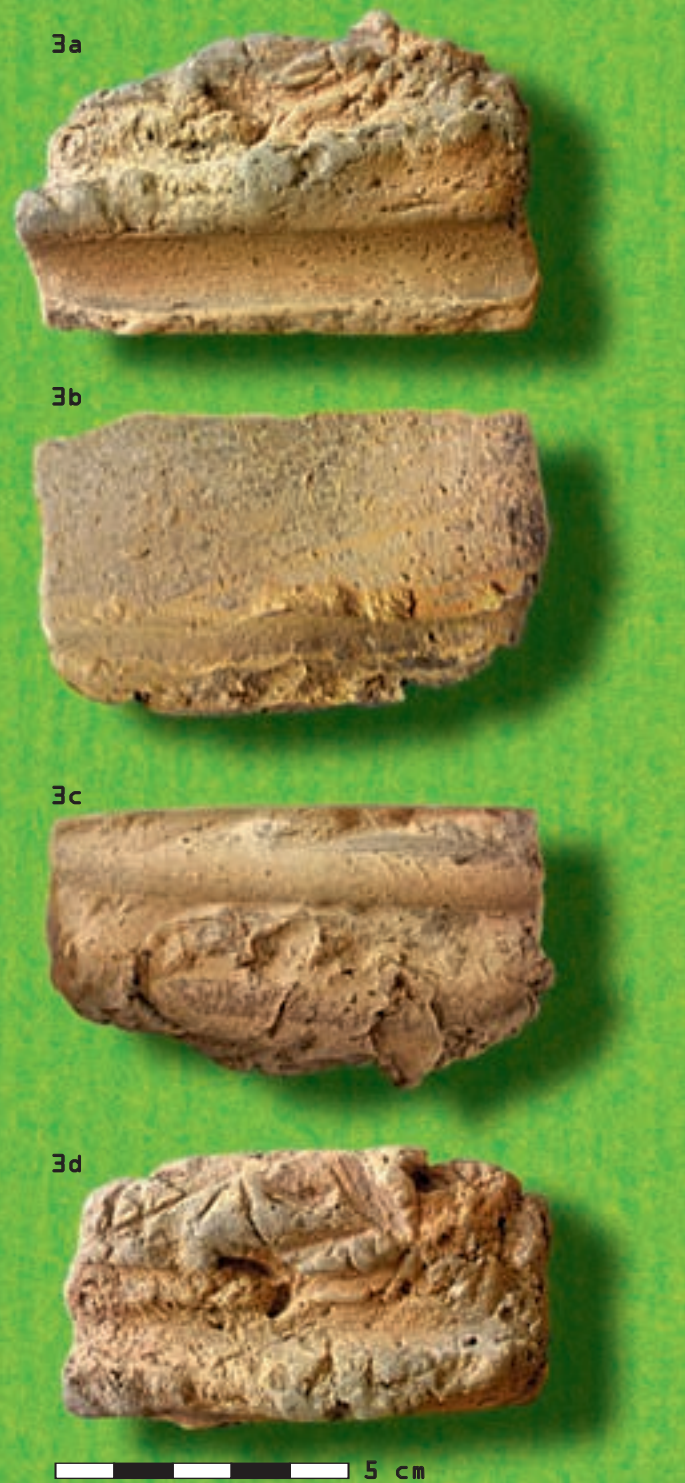
Abb. 3: Bronzezeitliches Hüttenlehmfragment. a: Ansicht von oben mit Rutenabdrücken, wulstigen Vorwölbungen und Grasabdrücken. b: Glattgestrichene Wandseite. c: Ansicht von unten. d: Grasabdrücke auf der Seite, die dem Wandverstrich gegenüber liegt. Foto: I. Staeves
