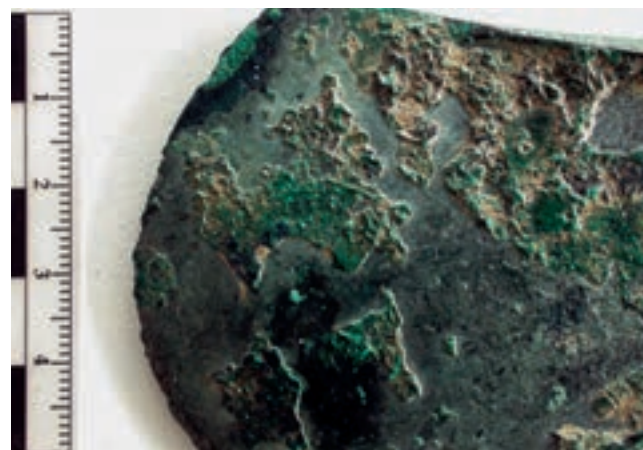
Abb. 9: Korrosion auf einem bronzenen Randleistenbeil. Foto: R. Riens.
