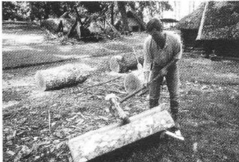
Abb. 5: Radiales Aufspalten der Stammsegmente zu Bohlen.
