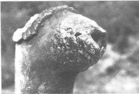
Abb. 7: Verschlackte, eingerissene Mündung einer Winkeldüse.
