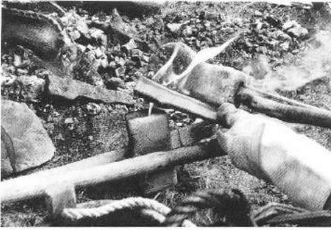
Abb 3: Gießen eines Beiles.
