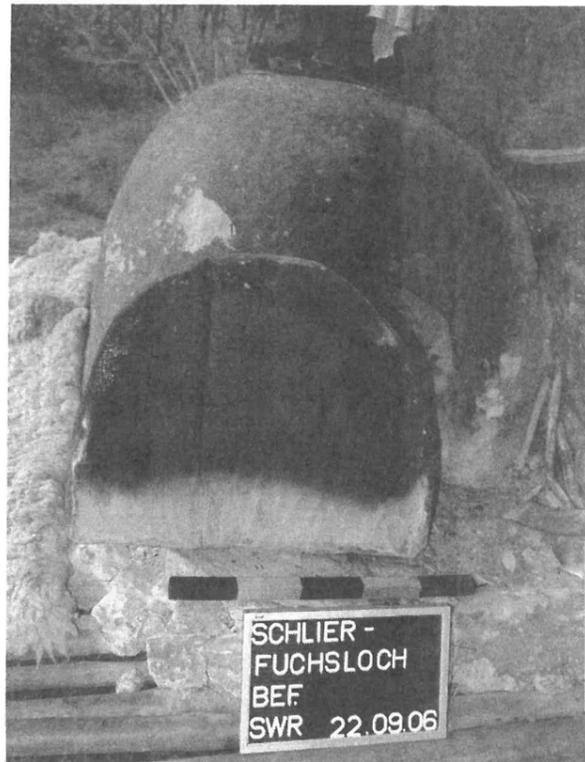
Abb. 20: Wie lange hält bei Dauerbefeuerung ein Verschlussbrett für einen Kuppelbackofen aus Holz?
