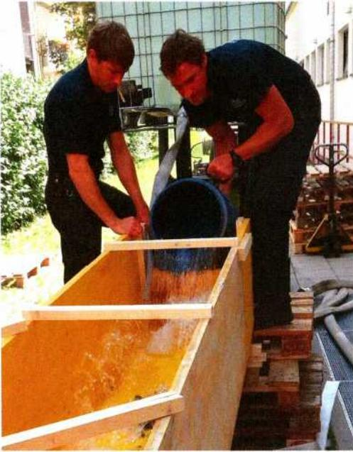
Abb. 10: „Aktive Schwallspülung“ mit 60 l Wasser. – “Active Surge Flushing” with 60 l of water.
