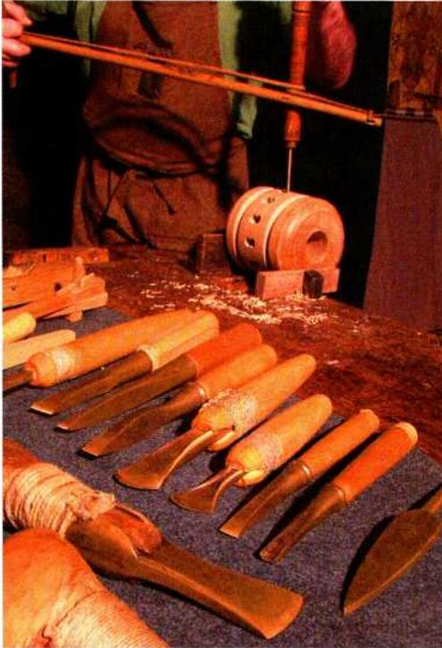
Abb. 2: Die Ausnehmungen für die Speichen wurden mit einem Bronzebohrer an den Radnaben vorgebohrt. Im Vordergrund Nachbildungen von Bronzezeitwerkzeugen. – First the recesses for the spokes were drilled in the wheel hubs with a bronze drill. In front some remakes of Bronze Age tools.
