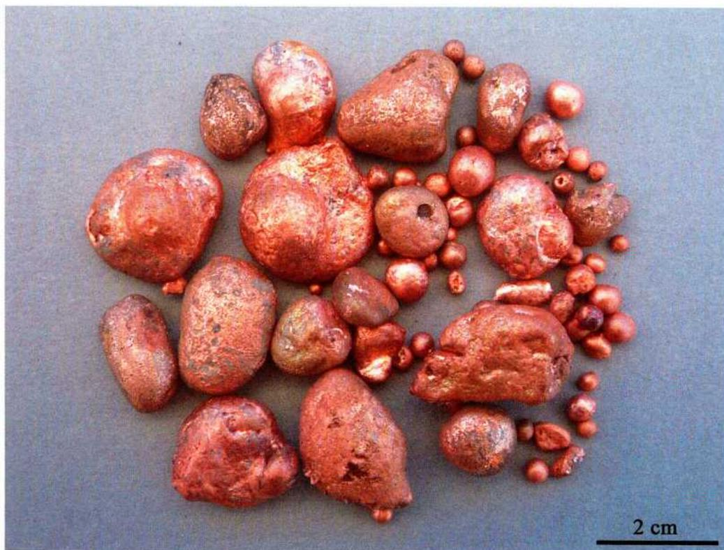
*Abb. 8: Schmelzperlen aus Kupfer, die in einem Pellet durch Aufschmelzen von porösen Kupferaggregaten entstanden sind. Einige der größeren Schmelzperlen sind durch Zusammenschmelzen von kleineren Schmelzperlen entstanden. – Beads of ductile copper, generated by re-melting the porous copper from inside the pellets. Some of the large beads are formed by fusion of smaller beads.*
