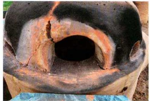
Abb. 5: Gravierende Risse in der Ofenkuppel nach dem BFP2013. – Severe cracks in the glass furnace dome after the BFP2013.
