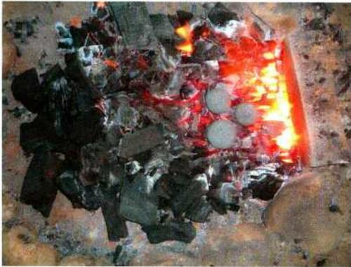
Abb. 2: Pellets in einem Holzkohlefeuer. Die Luftzufuhr erfolgt von der Seite aus, um ein Temperaturgefälle zu erzeugen. – Pellets in a bed of charcoal. The air supply is from one side only to generate a temperature gradient.
