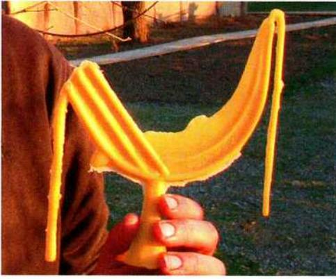
*Abb. 4: Die gewünschten Gussobjekte wurden zuerst aus Bienenwachs geformt, das später aus den Lehmformen ausgeschmolzen werden konnte. – First our casting objects were formed out of beeswax that could later be melted out from the clay moulds.*
