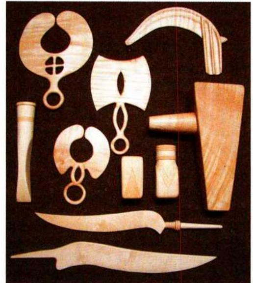
*Abb. 1: Um Wachsmodelle in beliebiger Menge herstellen zu können, haben wir unsere Objekte zuerst aus Ahornholz geschnitzt und mit diesen Holzformen eigene Gussformen für die Wachsmodelle angefertigt. – To produce a broad range of wax models, we first carved our objects in maple wood and made special moulds for the wax preforms.*
