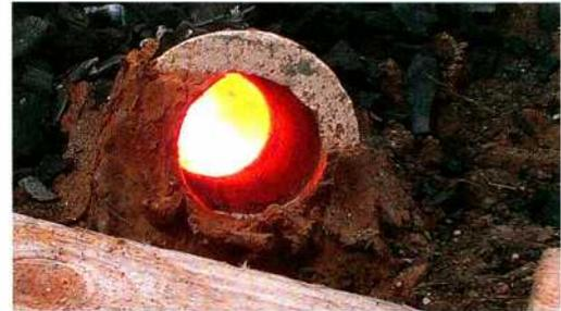
Abb. 17: Looking down the clay tuyere into the furnace during a smelt. The flame colour indicates a temperature of about 1100°C. – Blick durch die Lehmduese in die Schmelzgrube während des Schmelzprozesses. Die Farbe der Flamme zeigt eine Temperatur von etwa 1100°C an.
