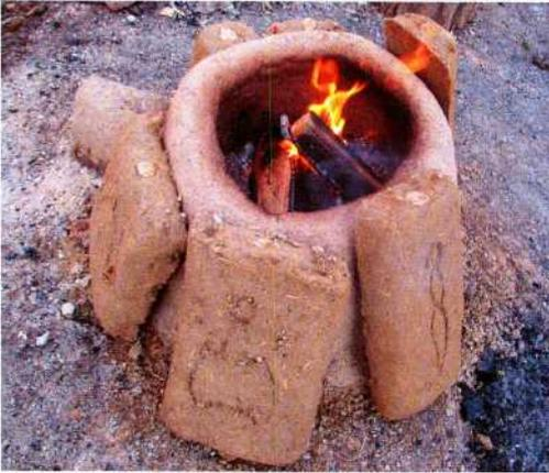
Abb. 5: Die gut getrockneten Lehmformen werden am Ofen behutsam erhitzt, um das Wachs ausschmelzen zu können. – The well dried clay moulds are carefully heated beside the oven to melt out the wax.
