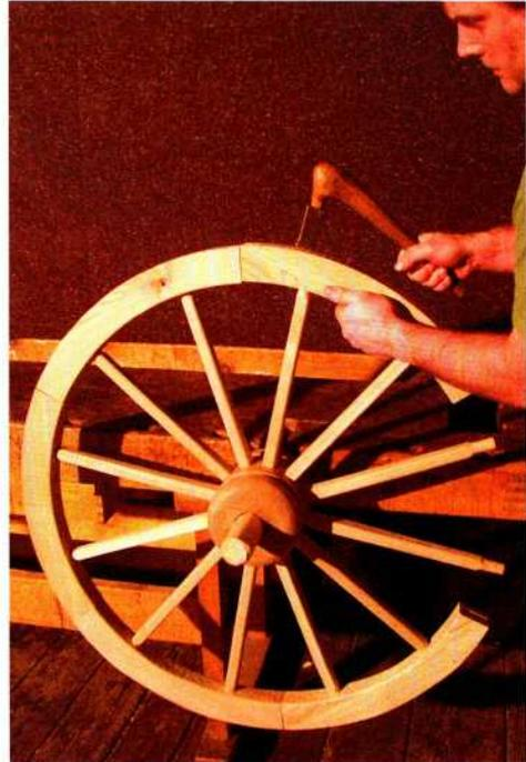
*Abb. 4: Die einzelnen Bestandteile der Felgen wurden mit einem Hammer auf die runden Enden der Speichen aufgesetzt. – The single parts of the rims were put on the round ends of the spokes with a hammer.*
