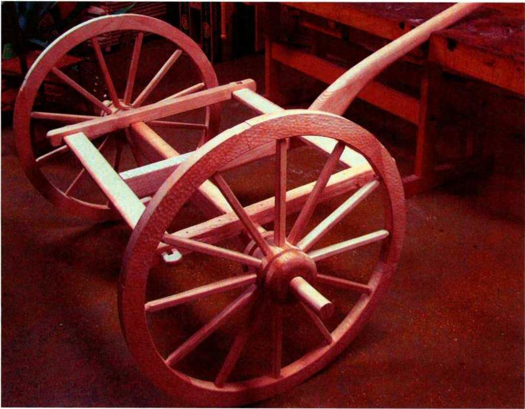
*Abb. 5: Der Unterbau des Streitwagenmodells mit Speichenrädern, Achse, Deichsel und Basisrahmen des Wagenkastens. – The subconstruction of the chariot model with spoked wheels, axis, pole and basis frame of the chariot box.*
