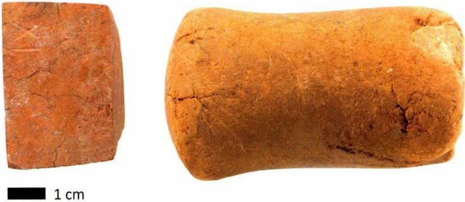
Abb. 5: Reduzierend, zehn Minuten, 800°C im Vergleich mit dem Original Kat. 669. – Reducing, ten minutes, 800°C compared to the original find cat. nr. 669.
