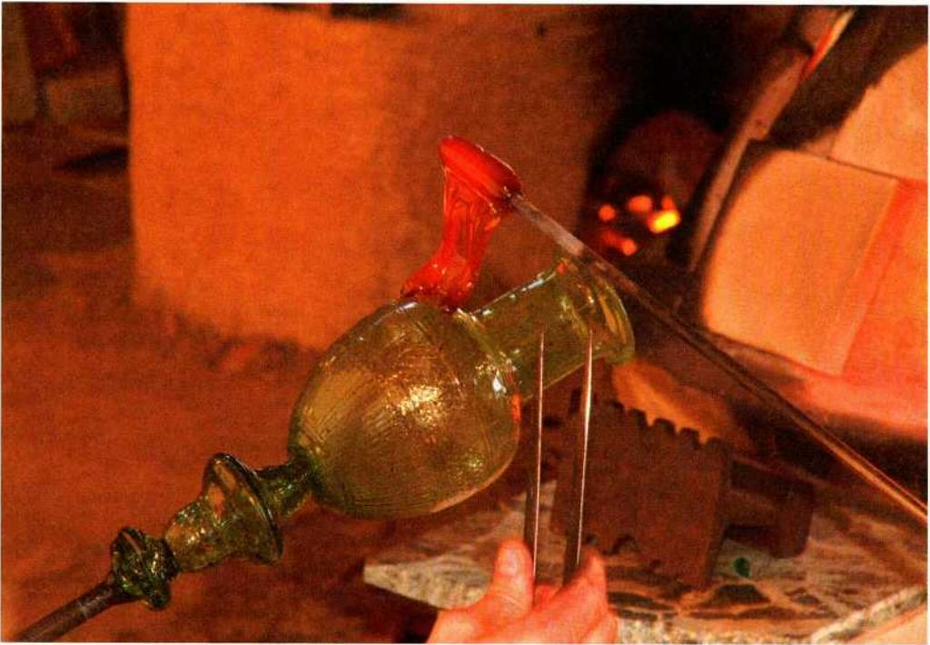
Abb. 7: Ansetzen des Henkels am ENNION-Krug beim BFP2014. – Attaching the handle to the ENNION jug at the BFP2014.
