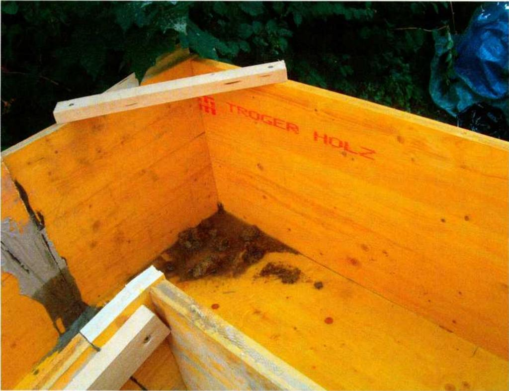
Abb. 13: Ansicht der Ecke 2 bei Zusatz von Kot, Metallteilen und Münzen nach „Aktiver Schwallspülung“ (Man beachte die Münzen, die im Hauptstrom liegen geblieben sind). – View of corner 2 during addition of excrement, metal parts and coins after “Active Surge Flushing” (note the coins which have remained lying in mainstream).
