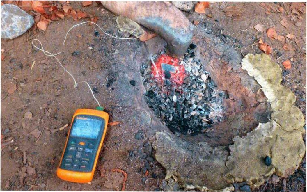
*Abb. 4: Die Ofenkonstruktion. Zu sehen ist ein oxidierender Brennversuch, die Steinprobe ist nicht mit Holzkohle überdeckt. Der Hotspot zeichnet sich durch die rot glühende Holzkohle ab. – A stone sample being heated in the furnace under oxidizing conditions. The top side of the sample is not covered with charcoal. The glowing charcoal marks the hot spot.*
