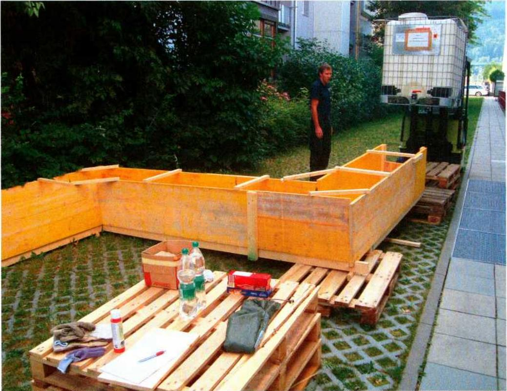
*Abb. 3: Versuchsanordnung am 26.6.2014: nachgebauter Latrinenkanal und Gabelstapler mit Wasserbehälter zur Wasserversorgung und Druckregulierung. – Experimental arrangement on 26.6.2014: reverse engineered latrine canal and fork lift truck with water container for water supply and pressure regulation.*
