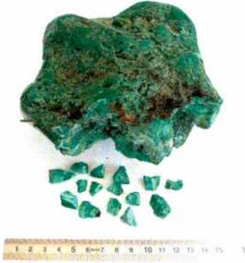
Abb. 1: Malachit-Abschläge, die für die Verhüttung nach der Pellet-Technologie verwendet wurden. – Pieces of malachite prepared for extracting copper using pellet technology.
