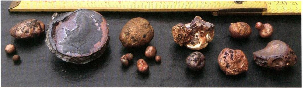
Abb. 10: Kupfernuggets verschiedener Versuchsdurchgänge. – Copper nuggets from different trials.
