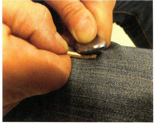
Abb. 5: Rezept 4: Anpolieren des mit Goldblech ummantelten Silberrundstabes. – Recipe 4: polishing the gold-coated silver wire.
