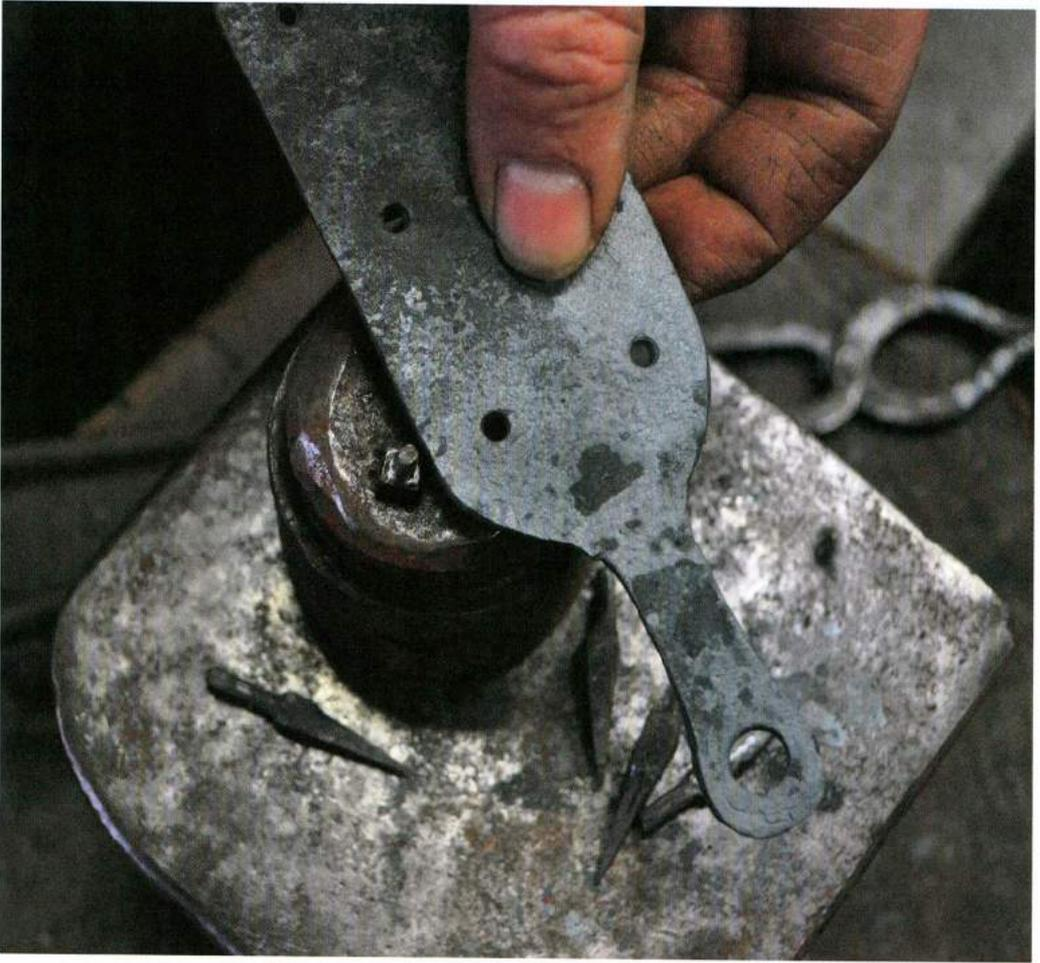
Abb. 8: Zinkenspitze im Gesenk mit Blick auf den Nietschaft. – Prong tips in the swage with a view on the rivet shaft.
