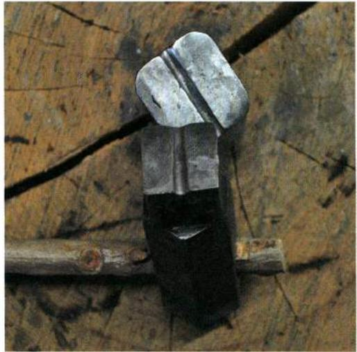
Abb. 3: Amboss und Setzhammer. – Anvil and set hammer.
