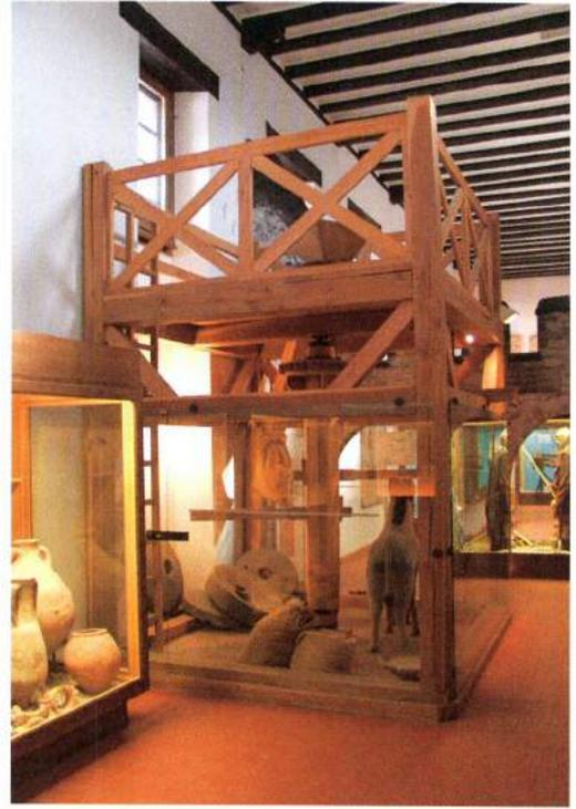
Abb. 12: Modell der großen Getreidemühle mit Göpelantrieb nach Baatz. – Modell of the grain mill with horizontal drive according to Baatz.
