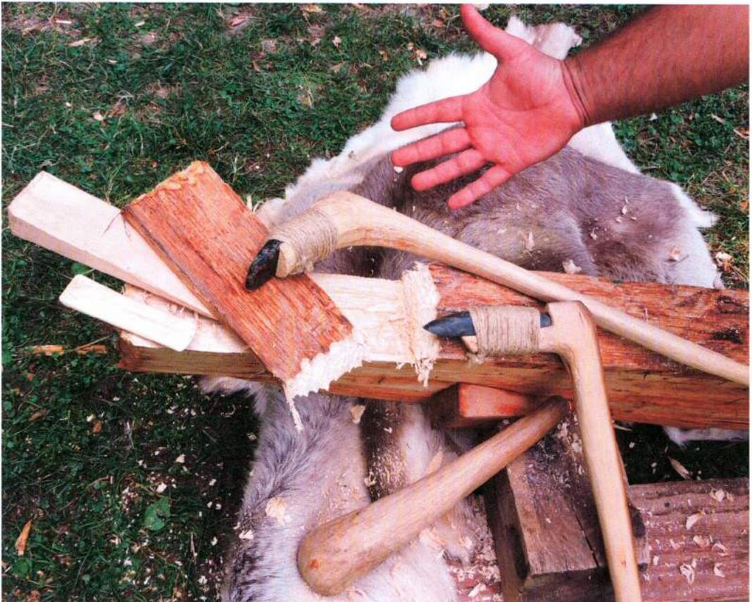
Abb. 7: Das Splintholz konnte auch mit Holzkeilen entfernt werden; im Bild: Knochenbeitel, Holzkeil, flachbreite und schmalhohe Dechselklingen auf offenen Knieholzschäften, Klopffholz. – The sap wood could also be removed with wooden wedges; in the picture: bone chisel, wooden wedge, broadflat and slimhigh adze blades fixed to blunt-angled knee shafts, wooden mallet.
