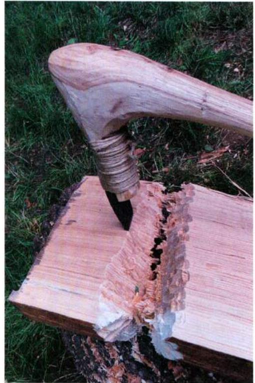
Abb. 5: Eine schmalhohe Dechselklinge wurde zum Abtrennen der Spaltbohlen eingesetzt. – A so-called slimhigh adze blade was used to cut off the split boards.
