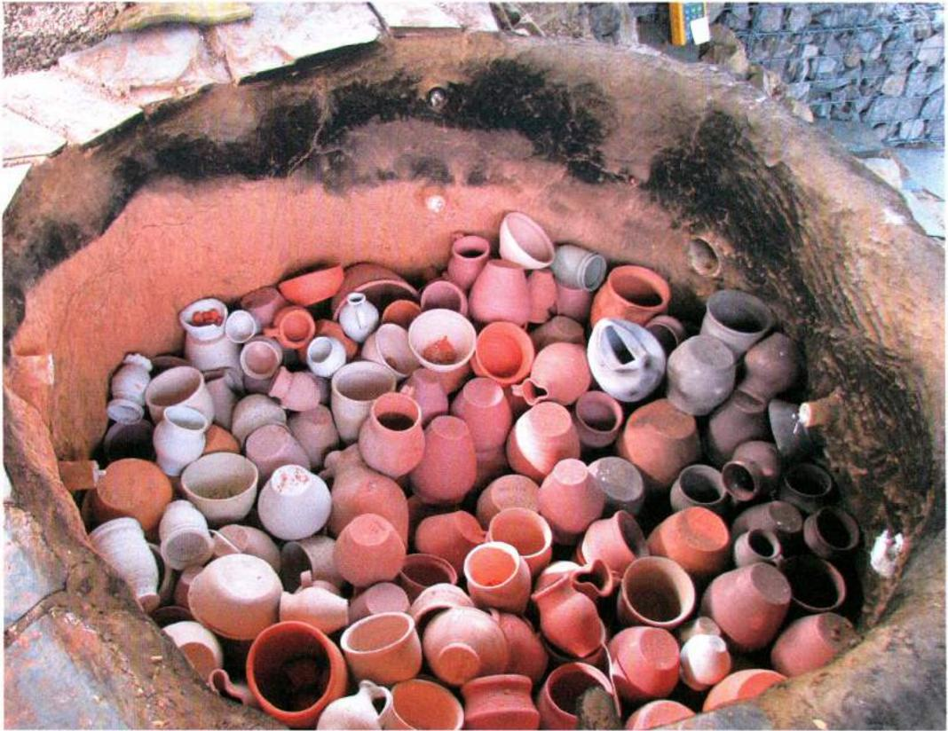
*Fig. 10: Pots after firing. The pots towards the front of the furnace (right hand side of picture) were grey to black, while those at the back (left) were light or red in color. – Die Töpfe nach dem Brand. Die Töpfe im vorderen Bereich des Ofens (rechts im Bild) sind dunkel gefärbt, während die im hinteren Bereich (links) eher hell bis rot sind.*
