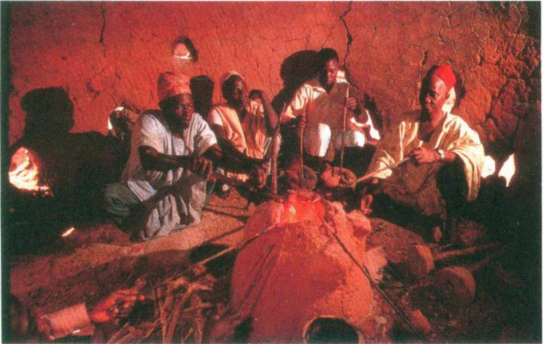
Abb. 12: Herstellung von Glasperlen an einem Schachtofen. Bida, Nigeria. – Winding beads using a shaft furnace. Bida, Nigeria.
