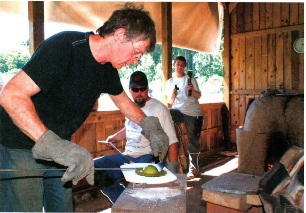
Abb. 12: Mark Taylor formt ein kuppelförmiges Fensterglas. – Mark Taylor shaping a domed window glass.
