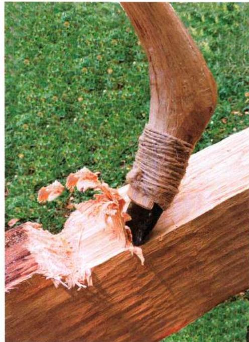
Abb. 6: Eine breitflache Dechselklinge auf einer ‚offenen‘ Knieholzschäftung mit einem Winkel von  $98^\circ$  wurde eingesetzt, um Splintholz zu entfernen. – A so-called ‚broadflat‘ adze blade on an ‚open‘ knee hafting with an angle of  $98^\circ$  was employed to remove the sap wood.
