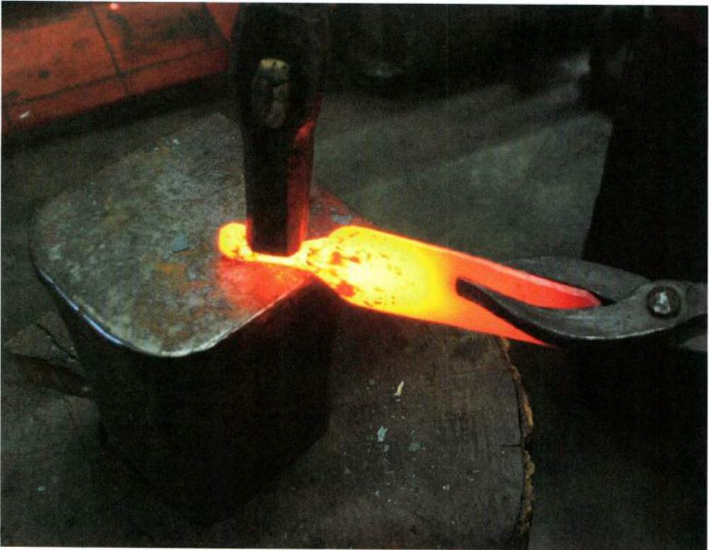
Abb. 4: Absetzen der „Steigeisenenden“ auf dem Schildamboss. – Placing the “crampons tips” on the shield-shaped anvil.
