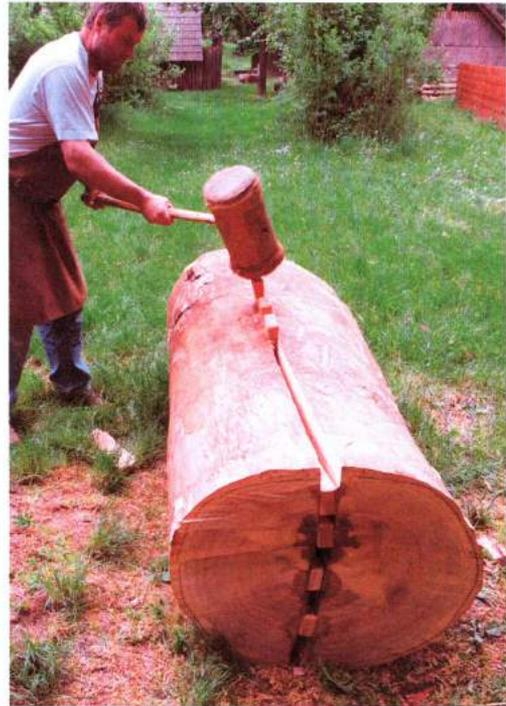
*Abb. 4: Erst nachdem wir mit mehreren Keilen am Stirnholz der Stammtrommeln die Rissrichtung vorgegeben hatten, wurden Keile an den Breitseiten eingeschlagen. – Several wedges driven into the trunks' end grain face enabled us to start initial cracks and determine their direction; then we hammered some more wedges into the trunks' outside in order to split them.*
