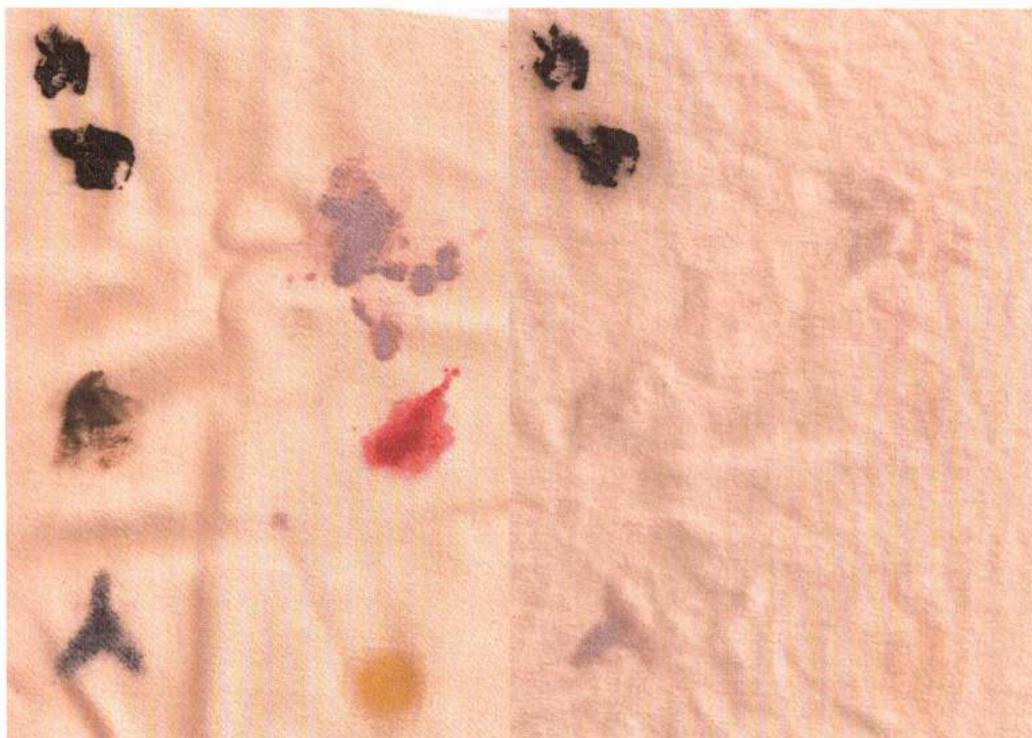
*Abb. 9: Wollstoff mit denselben Flecken wie oben vor (links) und nach (rechts) dem Waschen mit handelsüblichem Wollwaschmittel und kaltem Wasser. – Woolen cloth with the same spots as above before (left) and after (right) treating with today's commercially available laundry detergent and cold water.*
