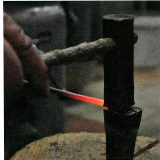
Abb. 6: Strecken und Ausformen des Nietschafte mit dem Setzhammer auf dem kleinen Amboss mit Sicke. – Stretching and beating out of the rivet shaft with a set hammer on a small anvil with a crease (crimp).
